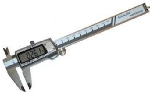
Slika 3: Kljunasto merilo za določanje velikosti popkov (Digitalni ..., 2014)
