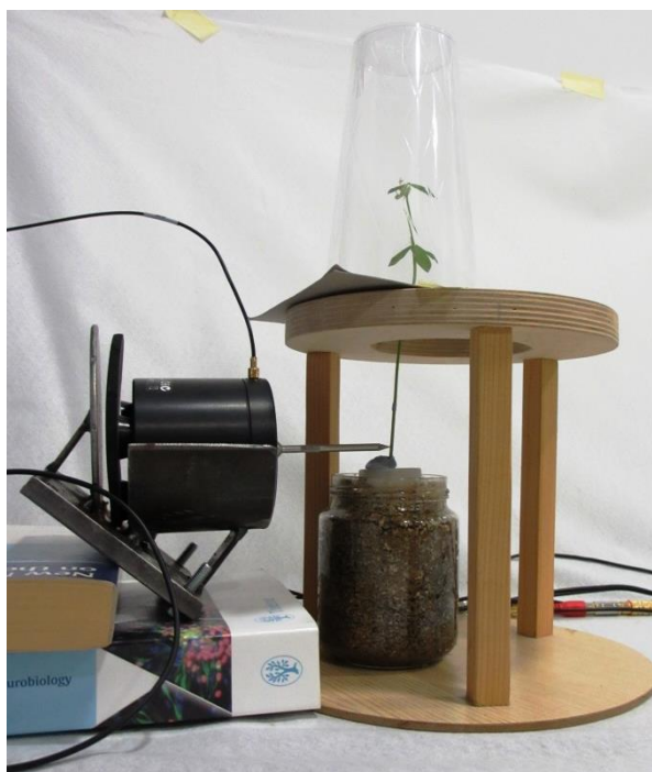
Slika 4: Eksperimentalna postavitve za registracijo vibracijskih signalov in predvajanje predhodno posnetih stimulacijskih signalov Figure 4: Experimental set-up for registration of vibrational signals and producing prerecorded stimulation signals
