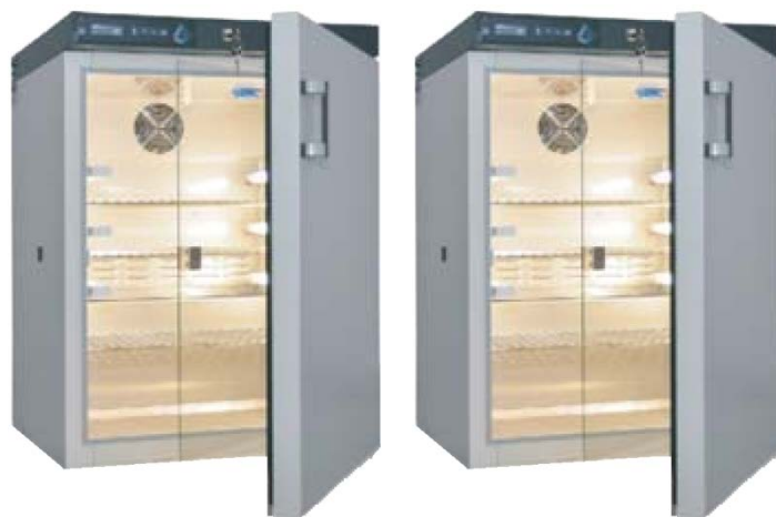
Slika 34: Enaki termostatski komori s fotoperiodnim sistemom ST3+/FOT6 (Pol Eko Aparatura, Wodzislaw Ślaski, Poljska) RK1 in RK2. Komori smo uporabili za poskuse v močnem statičnem magnetnem polju in nihajočem magnetnem polju.
