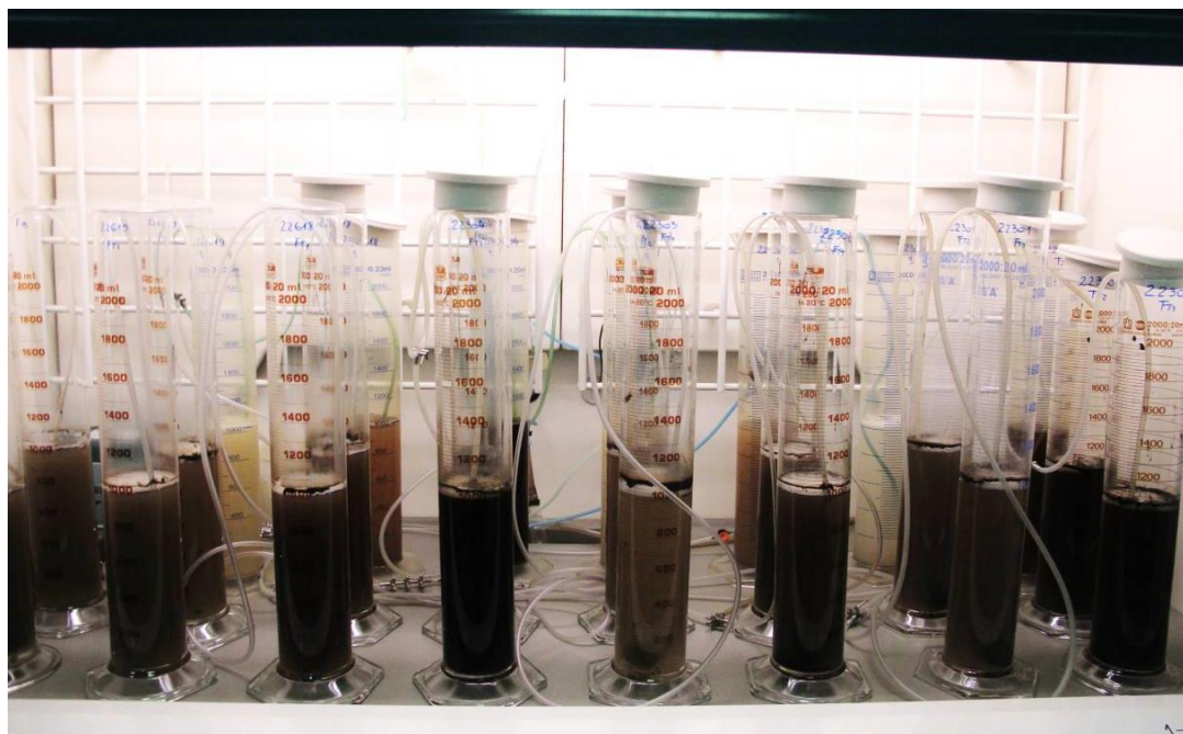
Slika 8: Test biorazgradljivosti po OECD 302 B “Zahn-Wellens/EMPA Test” (OECD, 1992)
