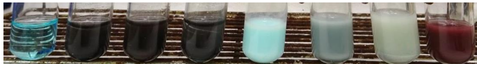
Slika 22: Topnost različnih bakrovih spojin v dH 2 O in oksalni kislini. Fotografije smo posneli 24 ur po reakciji, z leve proti desni: Cu sol, MD CuO, ND CuO in ND Cu v dH 2 O ter Cu sol, MD CuO, ND CuO in ND Cu v oksalni kislini.
