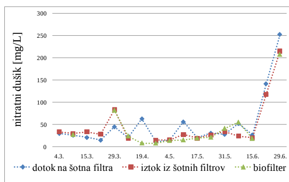
Slika 26: Prikaz izmerjenih koncentracij nitratnega dušika od začetka marca do konca junija 2011 na posameznih podenotah modula za črno vodo
