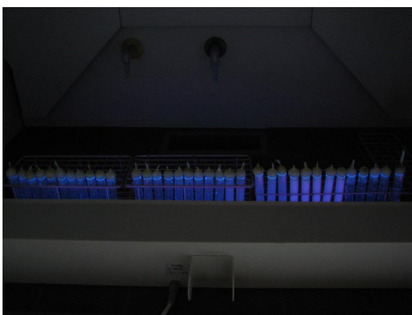
Slika 5: Poskus z obsevanjem testnih raztopin z UV-A svetlobo.
