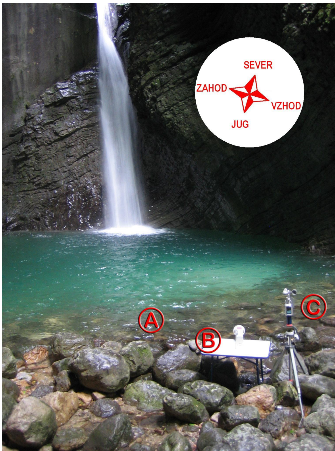
Slika 2: Vzorčna mesta pri slapu Kozjak, kjer smo pridobil vzorce »Voda tolmun« (A) ter »Zrak 1« (B). Poleg vzorčevalnika zraka je bila nameščena tudi meteorološka postaja (C), ki je merila zračni tlak, zračno vlago in temperaturo. Smer padca slapu je proti jugovzhodu.
