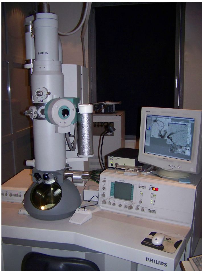
Slika 31: Presevni elektronski mikroskop PHILIPS CM-100 s CCD kamero za slikanje opazovanih vzorcev v digitalni obliki
