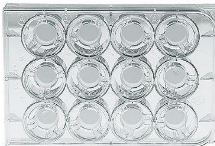
Slika 8: Ploščica s plastičnimi koški iz poliestra (transwell) s prepustno membrano (katalogni zapis, Corning Costar Transwell Permeable Supports)
