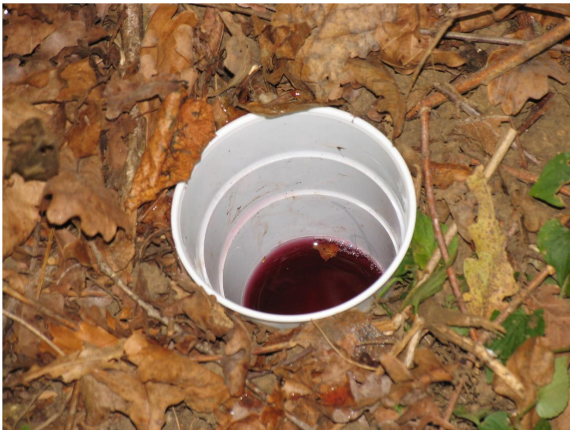
Slika 14: Talna past za krešiče. Na vrh smo dodali še streho iz lesa ali lubja, ki je preprečevala zalitje pasti v primeru dežja. Foto: Andrej Kapla (2011)
