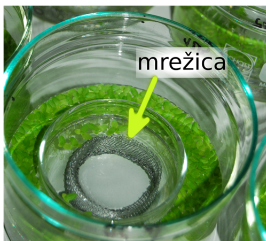
Slika 5: Aluminijaste mrežice zadržujejo rastline v manjših kristalizirkah čim bliže rastlinam v večjih kristalizirkah, tako da je omogočen kar najboljši prenos informacij z EMV.
