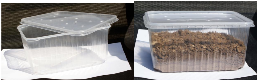
Slika 7: Pravokotna polipropilenska posoda (160 × 110 mm, volumen 1,5 l) s perforiranim pokrovom za izmenjavo zraka (Kos M., 2013)
