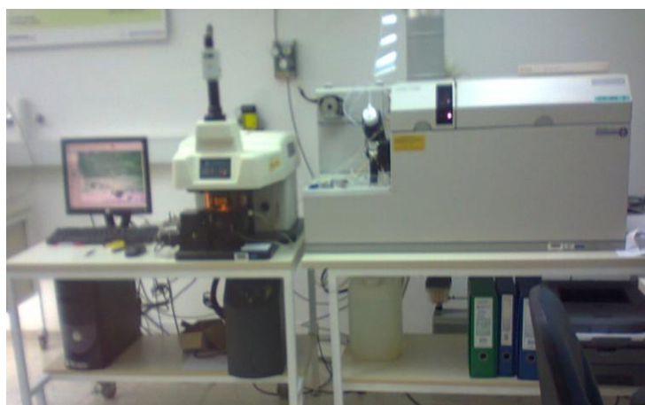
Slika 21: Naprava za lasersko ablacijsko ICP-MS (New wave UP 213-Agilent 7500ce) na Oddelku za analizo kemijo Kemijskega inštituta v Ljubljani. Od leve proti desni: en od dveh računalnikov za nastavitve parametrov, sprejemanje podatkov in krmiljenje sistema, laserski ablator, ICP-MS (Kos M., 2013)
