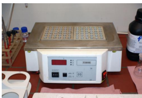
Slika 9: Termoblok z ročno nastavlјivim temperaturnim režimom (Kos M., 2013)
