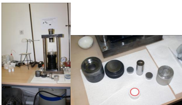
Slika 11: IR luč, hidravlična stiskalnica (levo) in sestavljeni kovinski model za pripravo tablet (desno) v Laboratoriju za rentgensko spektrometrsko analizo na Inštitutu Jožef Stefan v Ljubljani (Kos M., 2013)
