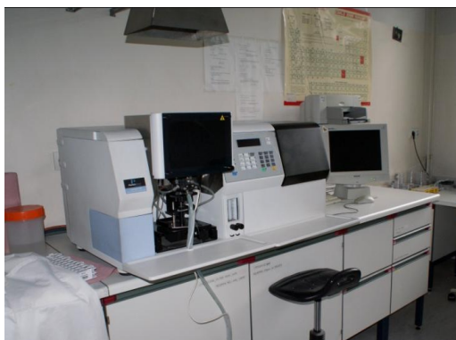
Slika 10: Plamenski atomski absorpcijski spektrofotometer Laboratorija za AAS na Katedri za zoologijo Oddelka za biologijo BF (Kos M., 2013)
