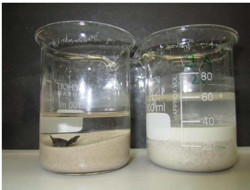
Slika 9: Testna posoda s sedimentom brez kaolina (levo) in s kaolinom (desno)
