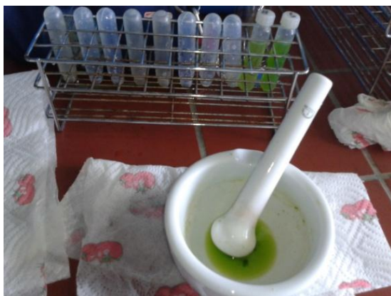
Slika 6: Delo v laboratoriju – trenje lista in ekstrakcija barvil v topilu (levo), priprava kivetve za merjenje absorpcije z UV-/VIS-spektrofotometrom (desno). (Foto: Eva Žemlja)
