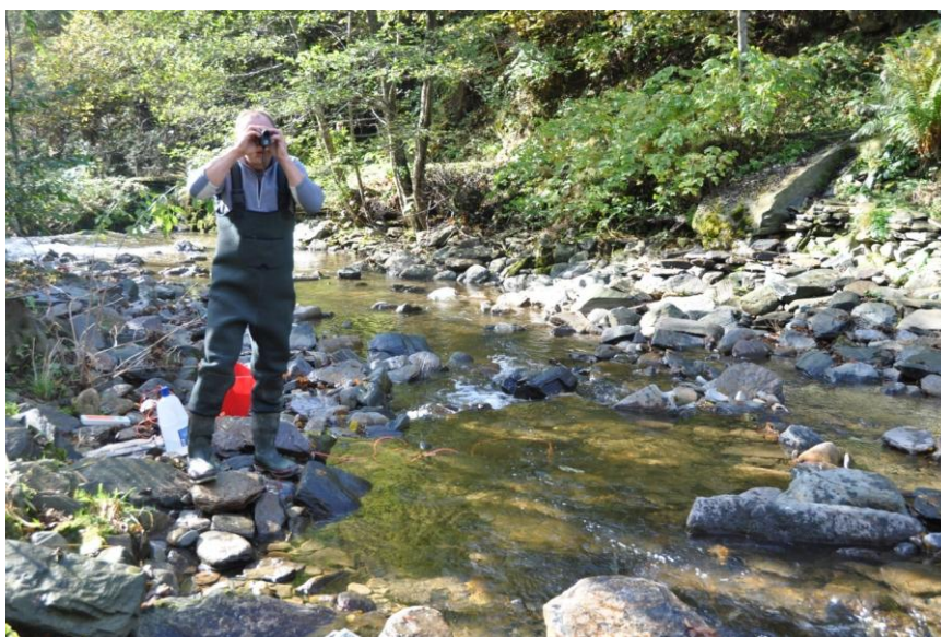
Slika 32: Meritev pretoka po metodi sledenja oziroma razredčenja raztopljenega sledila. Prikaz meritve pretoka s senzorjem v vodi in merjenja razdalje z laserskim merilcem (Foto: T. Prešeren, 2011).
