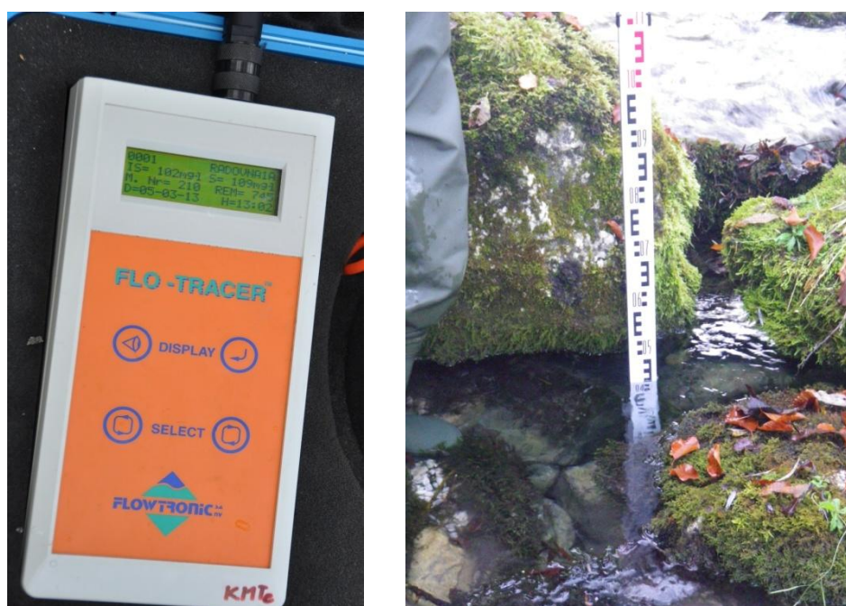
Slika 30: Prenosni merilec pretoka Flo-Tracer in prikaz merjenja globine vode z geodetsko lato (foto: M. Čarf, 2012).
