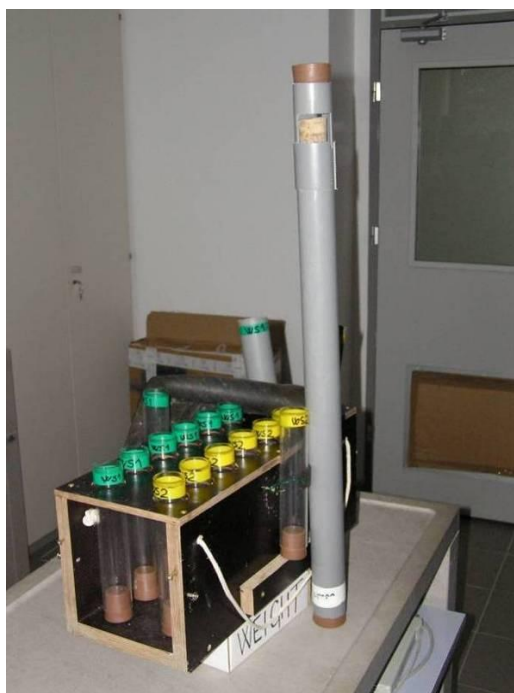
Slika 14: Transportna škatla za korerje in tulec za zamaške, v katerem se zamaški sami pomikajo proti odprtini na vrhu, ne morejo pa uiti iz cevi 11 .
