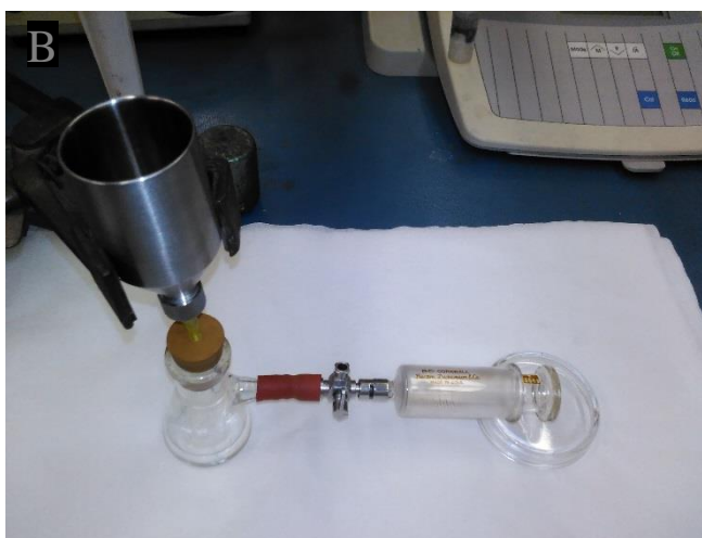
Slika 15: Millipore Filter Holder (A) in improvizirani sistem za filtracijo (B), ki smo ga pri našem delu uporabljali za pripravo preparatov za VEM.
