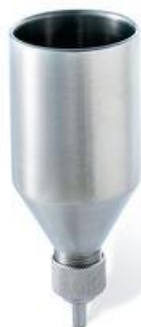
Slika 15: Millipore Filter Holder (A) in improvizirani sistem za filtracijo (B), ki smo ga pri našem delu uporabljali za pripravo preparatov za VEM.
