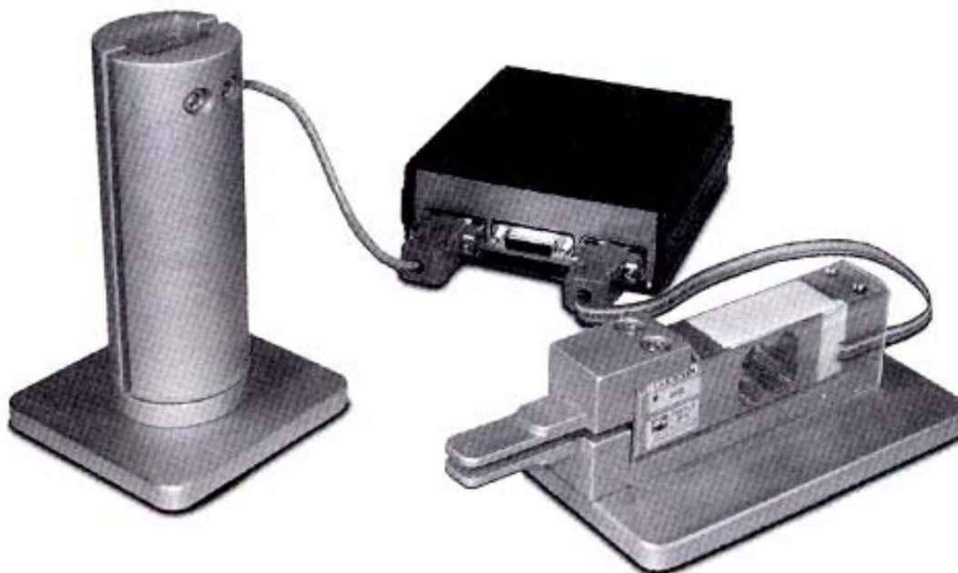
Slika 14: Naprava za merjenje sile prijema: vmesnik za močnostni prijem, vmesnik za precizijski prijem in elektronski vmesnik za ojačenje, pretvorbo in posredovanje signalov (Bajd in Kurillo, 2006)
