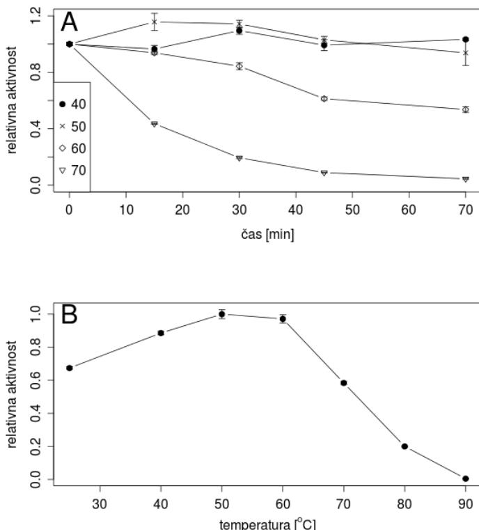
Slika 9: Termostabilnost lakaze ThioLacc. A – Rezidualna aktivnost lakaze po inkubaciji na povišani temperaturi; inkubacija do 70 min na 40 ali 50 °C ni zmanjšala aktivnosti lakaze ThioLacc. B – Maksimalna začetna hitrost oksidacije v odvisnosti od temperature; najvišjo aktivnost smo zabeležili pri 50 in 60 °C. Aktivnost je podana kot delež največje začetne hitrosti oksidacije ABTS pri pH 5,0, podana so povprečja in standardne napake (N=3).
