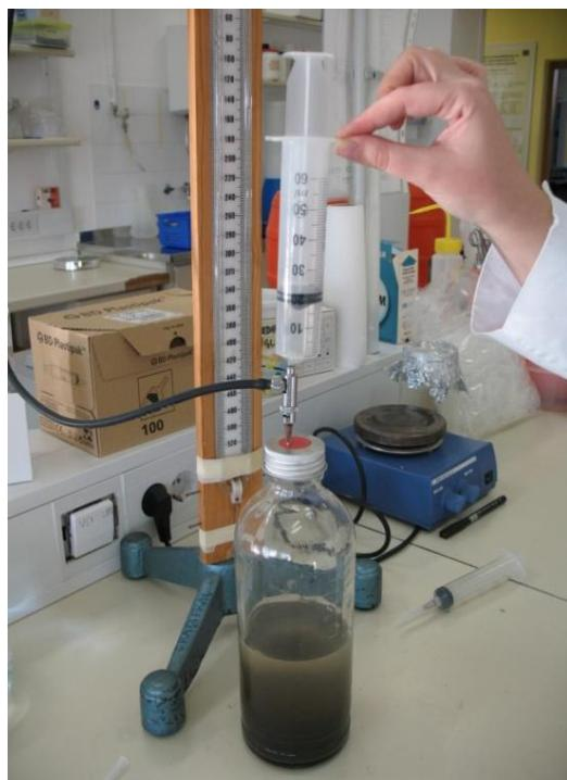
Slika 7: Postopek merjenja volumna nastalega bioplina z manometrom na vodni stolpec in brizgalko.
