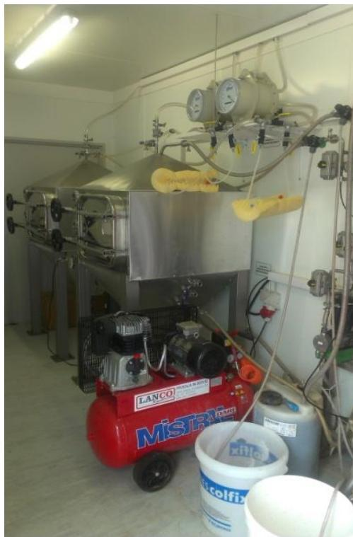
Slika 5: Pilotna bioreaktorja s pretočnimi merilniki nastalega bioplina, črpalkami odpadne vode in steklenima kivetama za vzorčenje bioplina za nadaljnje analize sestave bioplina.
