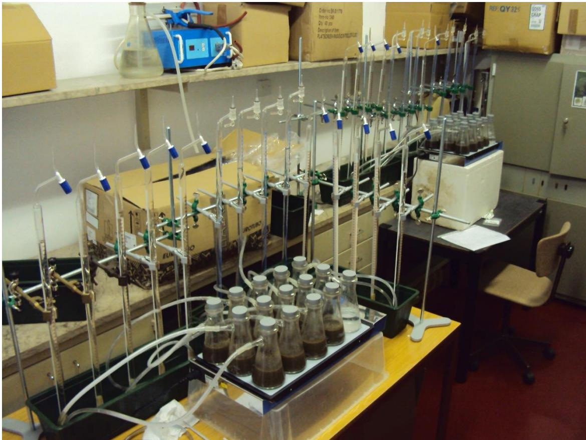
Slika 13: Laboratorijska aparatura za produkcijo bioplina in spremljanje nastale količine le-tega.
