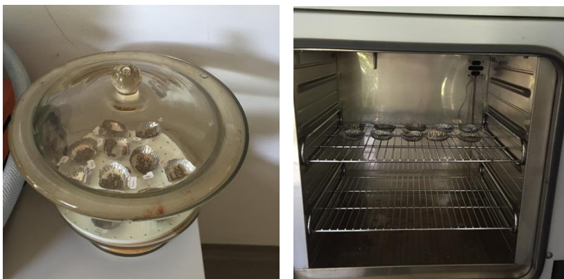
Slika 4: Oprema za določanje vsebnosti vlage v tleh: eksikator (levo) in pečica za sušenje vzorcev tal (desno).
