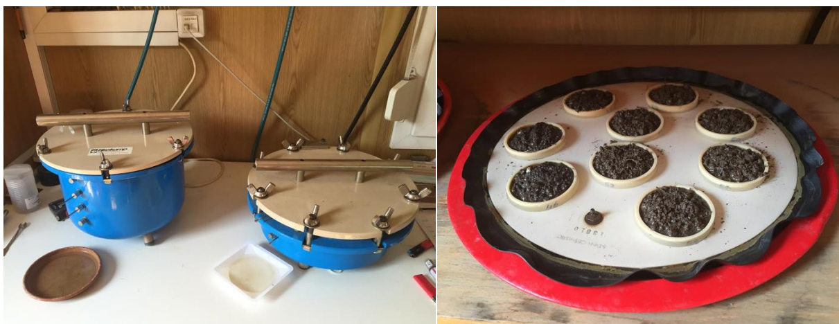
Slika 5: Komora za določanje vodno zadrževalnih lastnosti tal (levo) in obročki na keramični plošči, napolnjeni s tlemi, ki je nasičena z vodo (desno)
