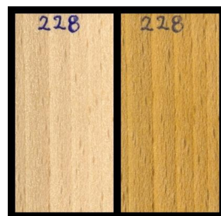
Slika 3: les bukve, izpostavljen glivi trohnikovki Plo (8 tednov)
