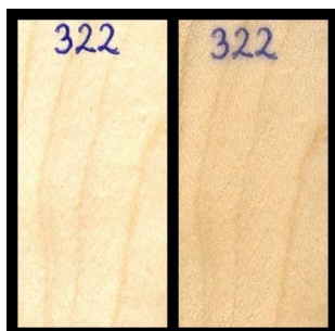
Slika 13: les javorja, izpostavljen glivi Ce pi 2 (6 tednov)
