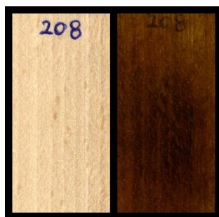
Slika 11: les bukve, izpostavljen 5 plesnim (5 tednov) in glivi trohnivki Hf (5 tednov)
