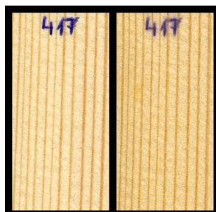
Slika 41: les smreke, izpostavljen glivi Glu (6 tednov)
