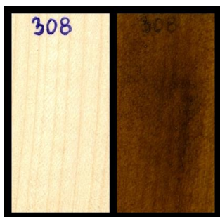
Slika 22: les javorja, izpostavljen 5 plesnim (5 tednov) in glivi trohnivki Hf (5 tednov)
