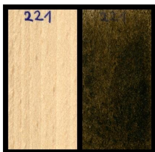
Slika 1: les bukve, izpostavljen glivi Sp (6 tednov)
