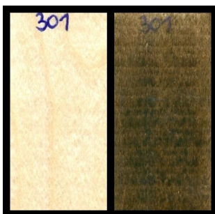
Slika 16: les javorja, izpostavljen 5 plesnim (6 tednov)
