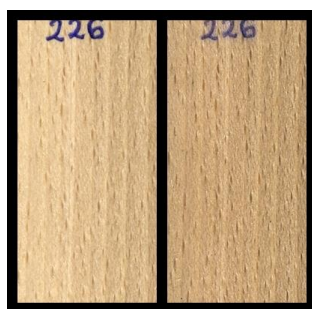
Slika 5: les bukve, izpostavljen glivi Karin (6 tednov)
