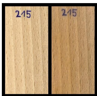
Slika 4: les bukve, izpostavljen glivi Fus (6 tednov)
