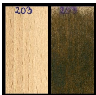
Slika 8: les bukve, izpostavljen 5 plesnim (6 tednov)
