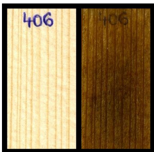
Slika 46: les smreke, izpostavljen 5 plesnim (5 tednov) in glivi trohnivki Plo (5 tednov)
