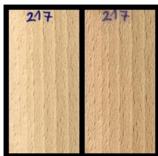
Slika 2: les bukve, izpostavljen glivi Glu (6 tednov)
