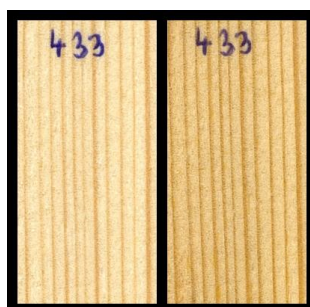
Slika 44: les smreke, izpostavljen glivi trohnivki Hf (8 tednov)
