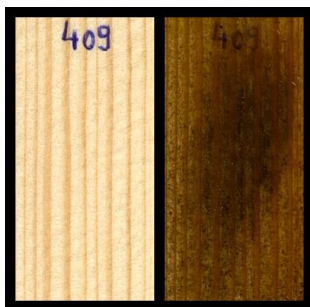
Slika 47: les smreke, izpostavljen 5 plesnim (5 tednov) in glivi trohnivki Hf (5 tednov)
