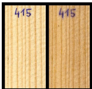
Slika 40: les smreke, izpostavljen glivi Fus (6 tednov)
