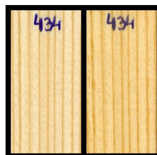
Slika 45: les smreke, izpostavljen glivi trohnivki Ff (8 tednov)
