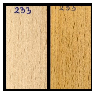
Slika 6: les bukve, izpostavljen glivi trohnikovki Hf (8 tednov)
