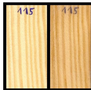
Slika 30: les bora, izpostavljen glivi Fus (6 tednov)
