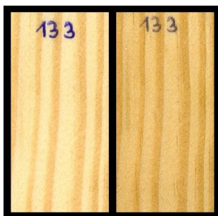
Slika 29: les bora, izpostavljen glivi trohnikovki Hf (8 tednov)
