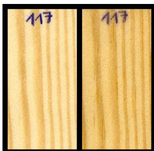
Slika 26: les bora, izpostavljen glivi Glu (6 tednov)
