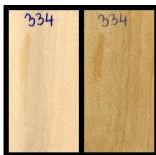
Slika 20: les javorja, izpostavljen glivi trohnikovki Ff (8 tednov)
