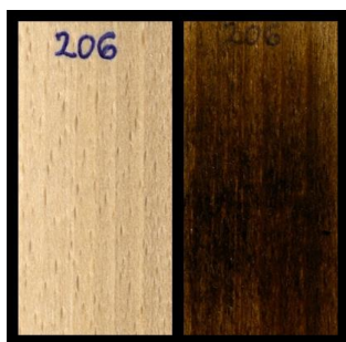
Slika 10: les bukve, izpostavljen 5 plesnim (5 tednov) in glivi trohnivki Plo (5 tednov)
