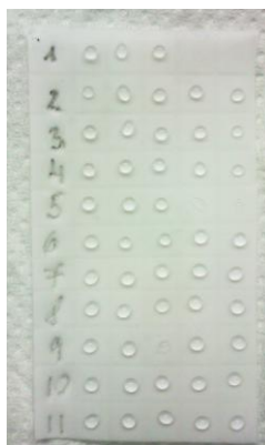
Slika 7: Nanos antigena ( 3 \mu\text{l} na kvadrataček) na membrano.
