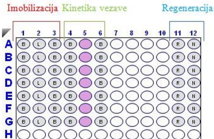
Slika 22: Plošča s pripravljenimi vzorci in regeneracijskim reagentom. B označuje pufer, L immobilizacijo, R regeneracijo, N neutralizacijo, roza polja označujejo vzorce
