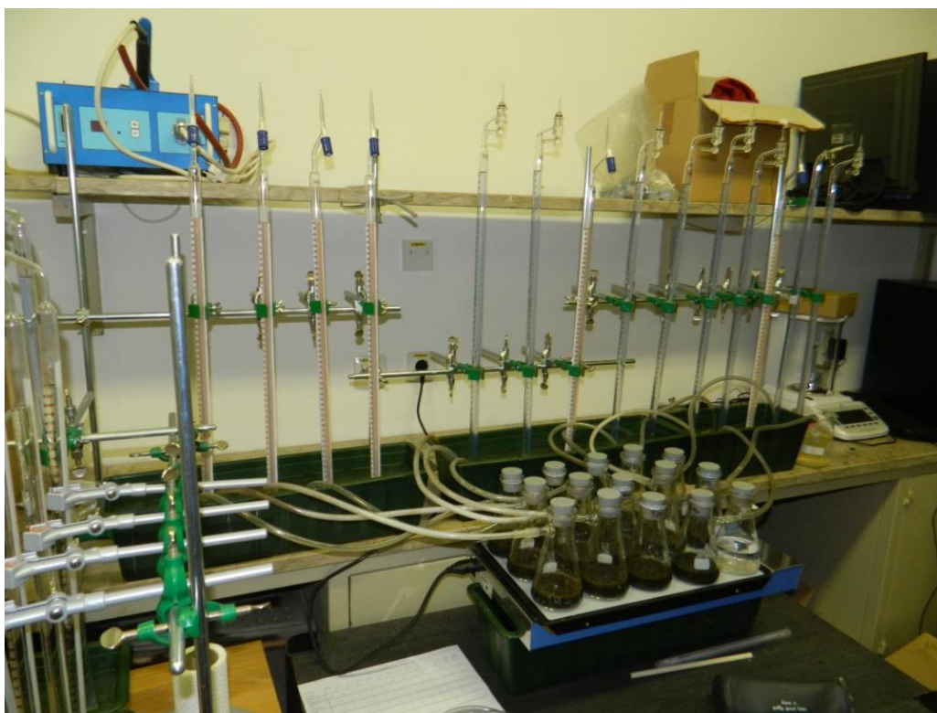
Slika 11: Aparatura za pridobivanje bioplina z anaerobno fermentacijo.
