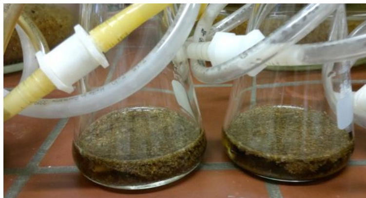
Slika 22: Erlenmajerice s substratom in z nepovratnim ventilom za produkcijo bioplina.
