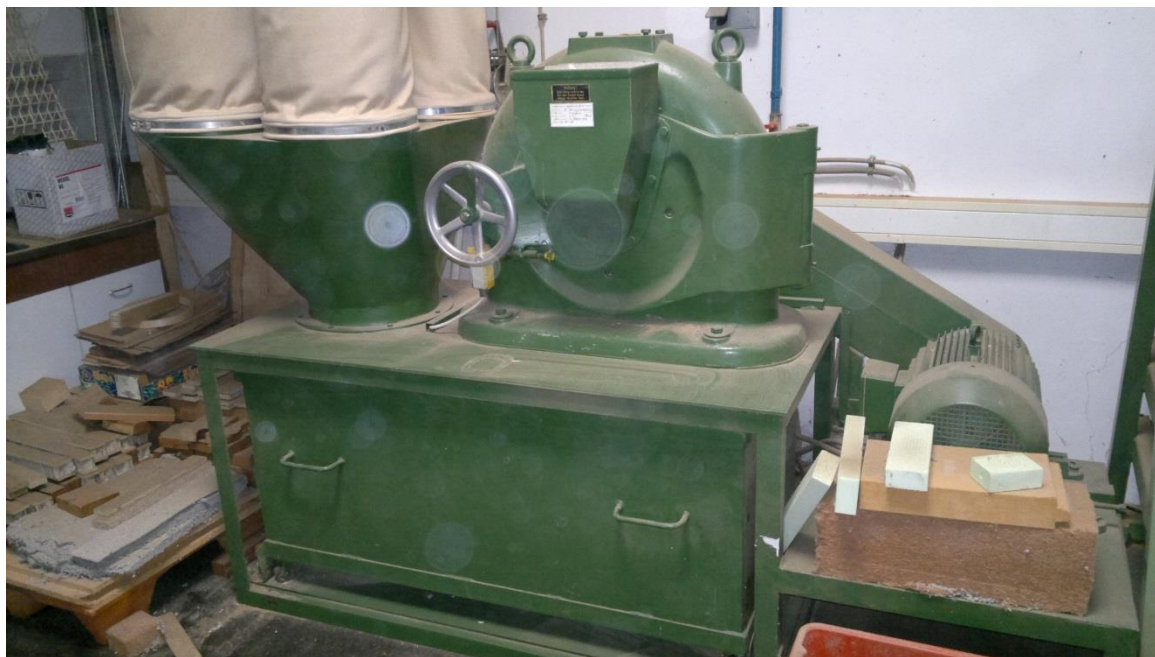
Slika 12: Križni mlin za mletje lignoceluloznega materiala.
