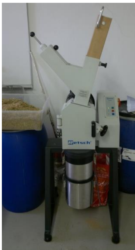
Slika 13: Mlin Retsch SM 2000 za fino mletje lignoceluloznega materiala.
