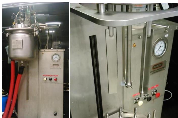
**Slika 18: BIAZZI – reaktor sistem (levo) in mešalo – turbina (desno).**
