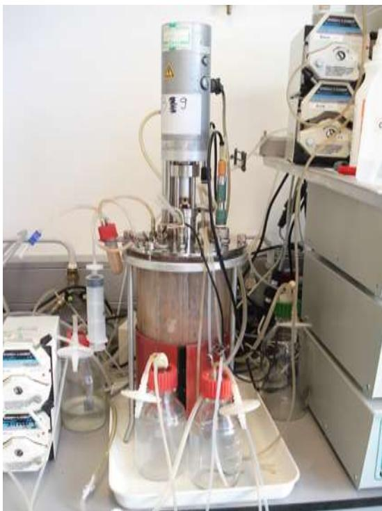
Slika 9: Bioreaktor Applikon z delovnim volumnom 4,8 L.
