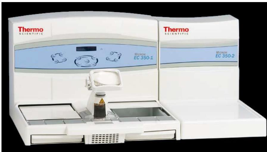
Slika 9: Prikaz mikrotoma MICROM EC 350-1/2 za obdelavo organov s parafinom (Thermo..., 2010)
