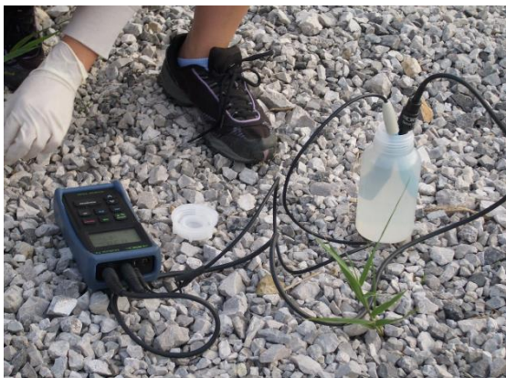
Slika 7: Primer merjenja in beleženja temperature, pH in prevodnosti, opravljeno pri vzorčenju V8.
