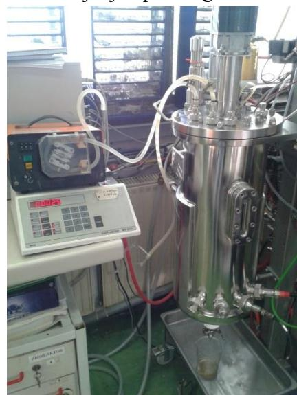
Slika 21: Na sliki je 30 l bioreaktor Techfors-S s spektrofotometrom za merjenje optične gostote.
