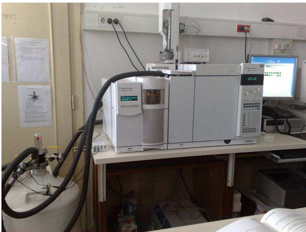
Slika 34: Plinski kromatograf Agilent Technologies 7890 (Agilent, ZDA) sklopljen s kvadrupolnim masnim spektrometrom Agilent Technologies 5975C (Agilent, ZDA).
