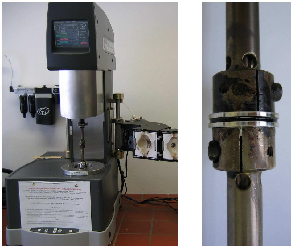
Slika 39: Reometer ARES G2-TA Instruments (levo) in vzorec med aluminijastima diskoma (desno).
