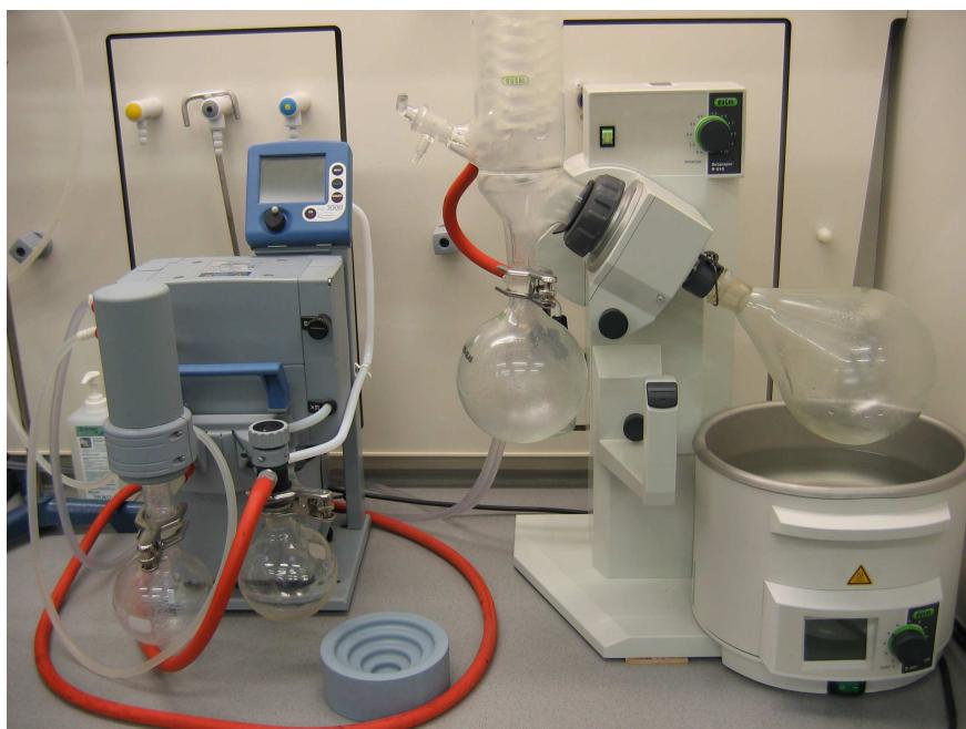
Slika 29: Rotavapor povezan z membransko črpalko.
