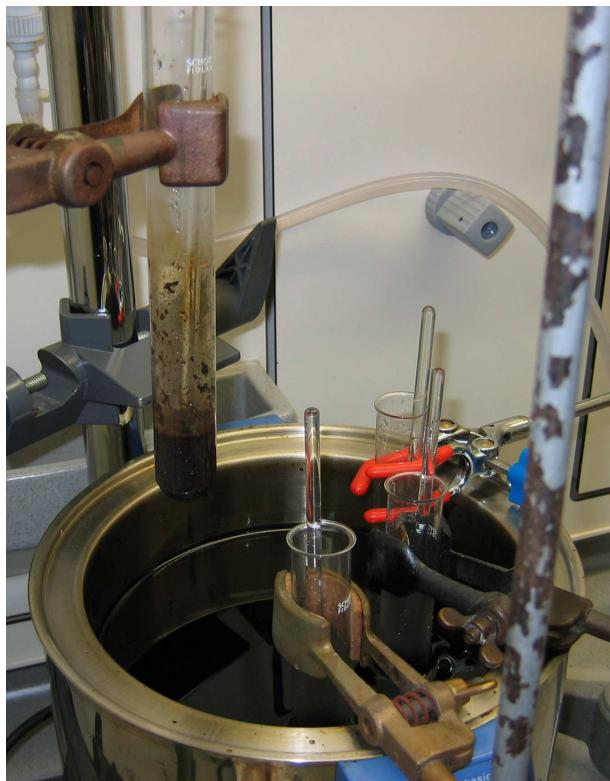
Slika 26: Utekočinjanje lesa v tankostenskih epruvetah.
