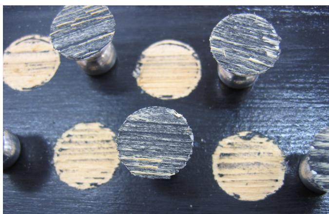
Slika 87: Adhezijski in kohezijski lom premaza 3 v dveh nanosih.
