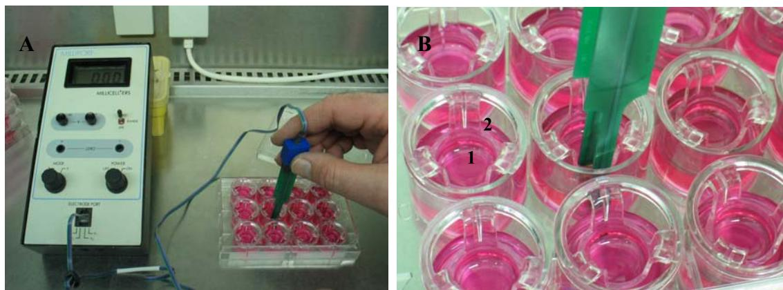
Slika 7: **Merjenje transepitelne električne upornosti (TEER) celic Caco-2.** (A): TEER celic smo merili z Volt/Ohm metrom in pripradajočim parom elektrod. (B): Eno elektrodo smo pomagali v gojišče nad filtrom (1) s plastjo celic, drugo pa v gojišče v predel pod filtrom (2).
