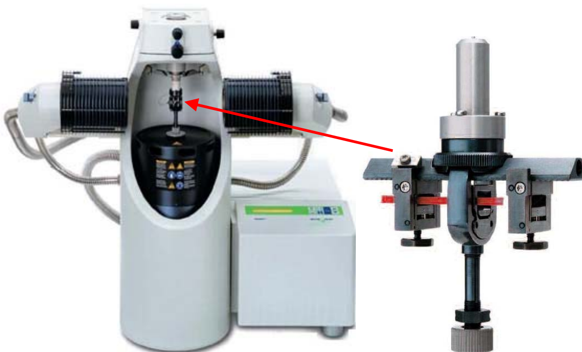
Slika 25: Naprava za izvedbo meritev DMA (Mettler Toledo DMA/STDA 861e) (levo) in enojno konzolno vpetje (desno)
