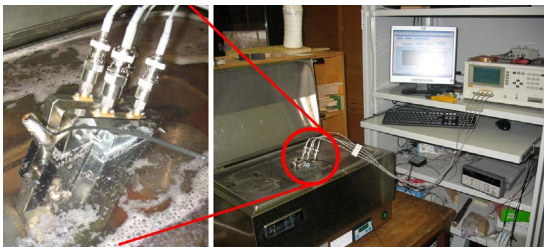
Slika 22: Merjenje dielektričnih lastnosti lepila v vodni kopeli pri povišani temperaturi (50 °C - 90 °C)
