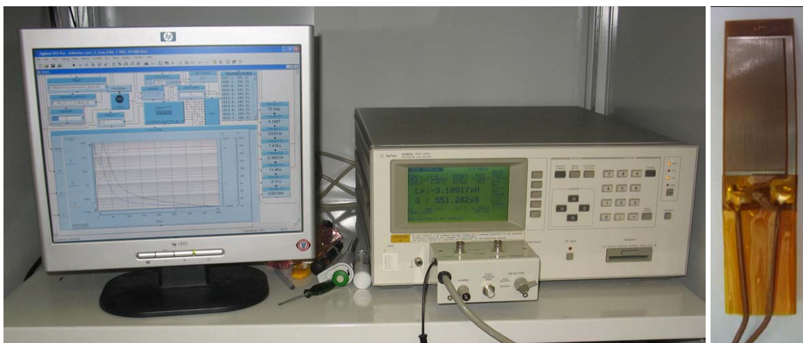
Slika 27: Agilent 4285A LCR Meter pripravljen za spremljanje utrjevanja z DEA (levo) in ploščati IDEX senzor (desno)
