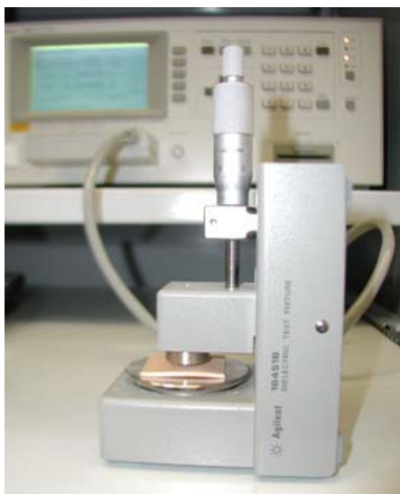
Slika 19: Sonda za merjenje dielektričnih lastnosti trdnih snovi (Agilent 16451B Dielectric Test Fixture)
