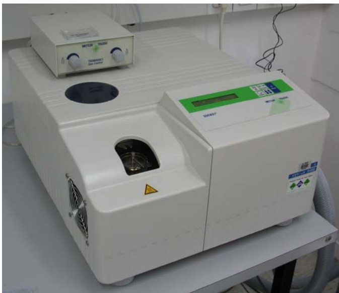
Slika 24: Naprava za izvedbo meritev DSC (Mettler Toledo DSC 821e)
