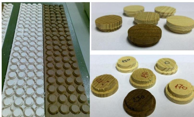
Slika 26: Lamele z vrezkanimi oblikami diskov (levo) ter izdelani diskovi pred končnim brušenjem (desno) iz lesa modificiranega pri različnih temperaturah
