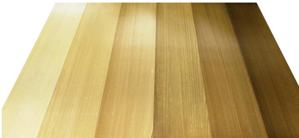
Slika 25: Razlika v barvi med lamelami modificiranimi pri različnih temperaturah (temperatura modifikacije od leve proti desni: kontrola, 150, 170, 190, 210, 230 °C)
