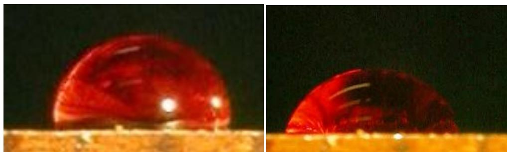
Slika 60: Kapljica FF lepila na površini termično modificiranega lesa (TM 220) na začetku (levo) ter po 60-ih sekundah (desno)
