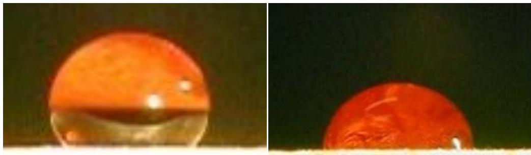
Slika 59: Kapljica FF lepila na površini nemodificiranega lesa na začetku (levo) ter po 60-ih sekundah (desno)
