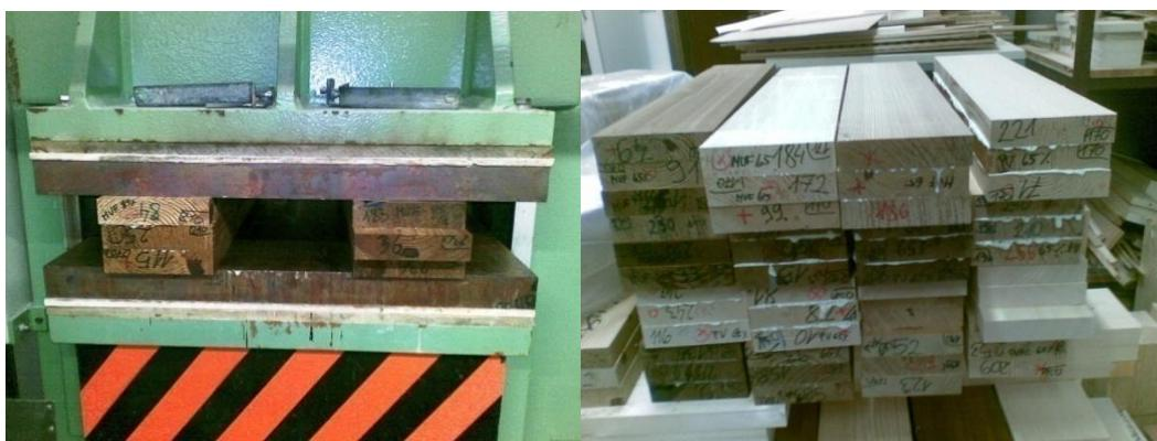
Slika 33: Lamele med stiskanjem v stiskalnici (levo) in zlepljene lamele po stiskanju (desno)
