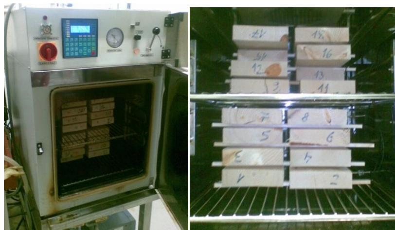
Slika 23: Nova komora za termično modifikacijo lesa (levo) ter lamele v komori pred termično modifikacijo (desno)
