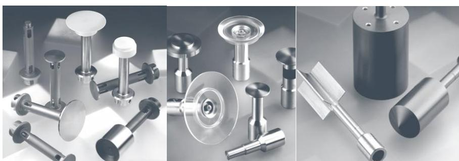
Slika 28: Različne geometrije merilnih orodij (TA Instruments-Rheometers, 2006)
