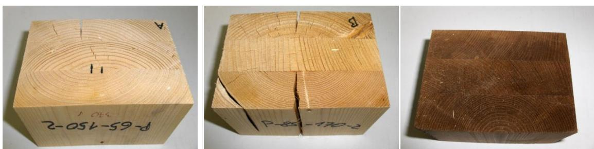
Slika 55: Primeri delaminacije PU lepilnih spojev pri preskušancih z različno stopnjo modifikacije lesa (TM 150, TM 170 in TM 230)
