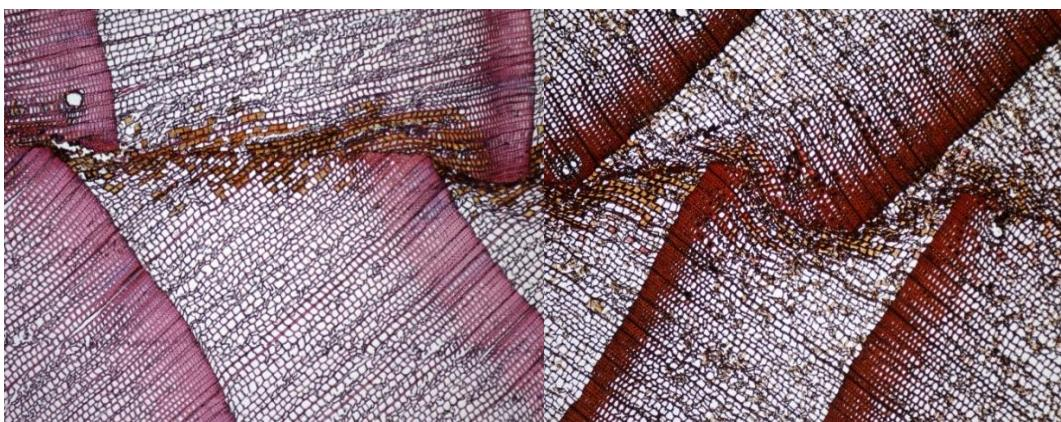
Slika 61: Mikroskopska slika prečnega prereza lepilnega spoja nemodificiranega lesa (levo) ter najbolj termično modificiranega lesa (desno), 4x povečava
