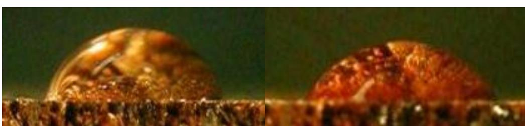
Slika 58: Kapljica vode na površini termično modificiranega lesa (TM 220) na začetku (levo) ter po 60-ih sekundah (desno)
