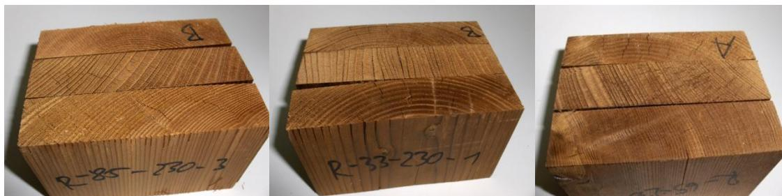
Slika 54: Primeri delaminacije PVAc lepilnih spojev pri preskušancih TM 230 iz lamel, pred lepljenjem klimatiziranih pri različnih RZV
