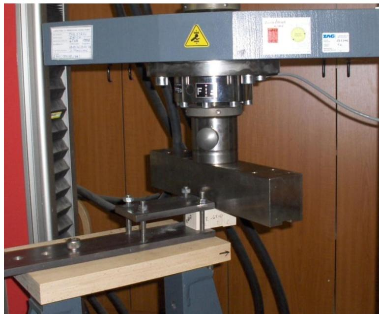
Slika 36: Testiranje strižne trdnosti z univerzalnim testirnim strojem Zwick Z100
