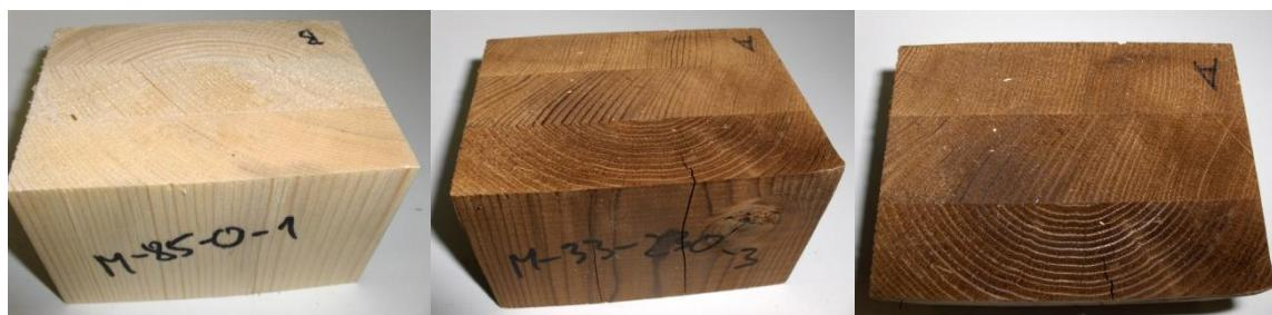
Slika 56: Primeri delaminacije MUF lepilnih spojev pri preskušancih z različno stopnjo modifikacije lesa (nemodificirani, TM 230)
