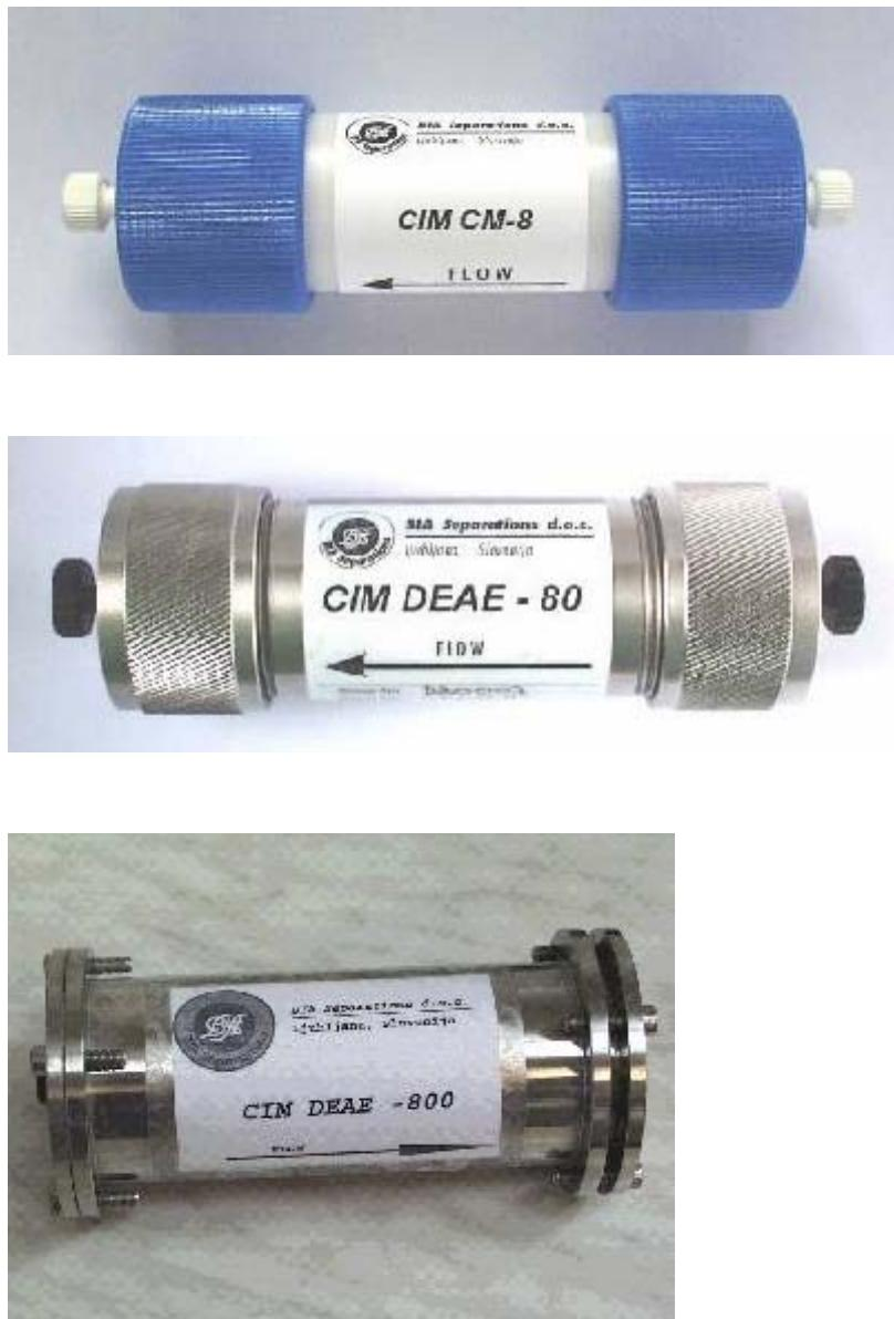
Slika 4. 8, 80 in 800 mL cevni moduli v ohišjih (CIM Tube..., 2005).
