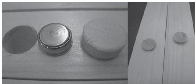
Slika 2: H-gumbek 23 za merjenje temperature in zračne vlažnosti ter njegova namestitev v vzorec.
