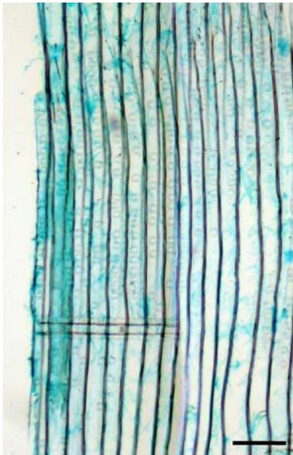
**Slika 5. Vosek je v prečni smeri prodrl le v prve poškodovane celice. Merilna daljica = 100 µm.**
