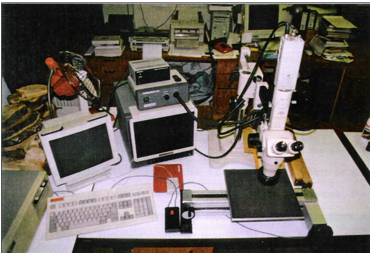
Slika 9 : Oprema za merjenje širine branik. Sestavni deli so merilna mizica, stereomikroskop, barvna video kamera, barvni video monitor in osebni računalnik.
