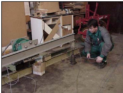
Slika 12: Kalibracija navora (levo) in mase na kolo (desno)
