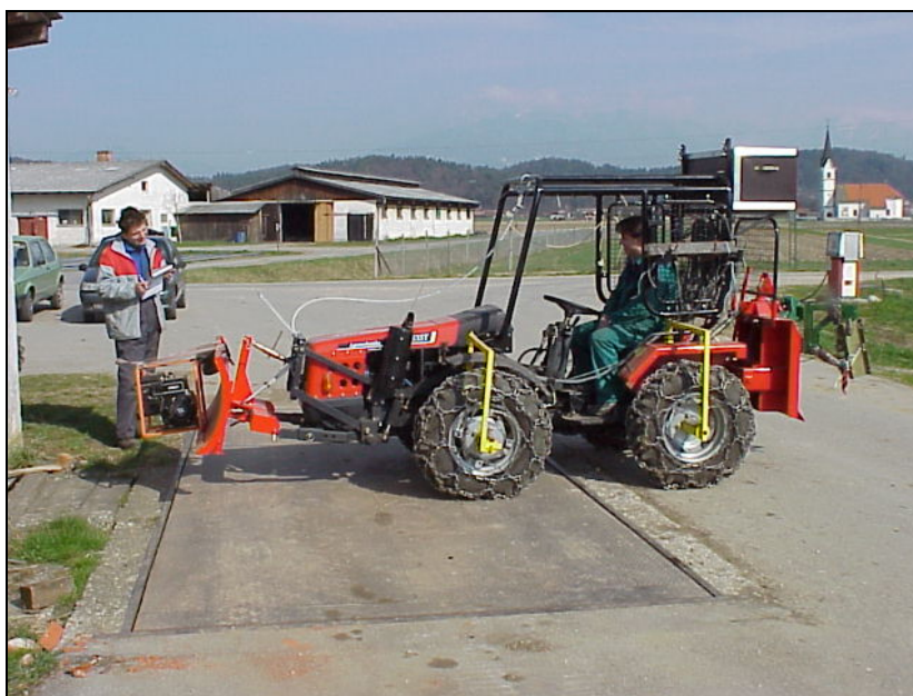
Slika 85: Tehtanje prednjega dela traktorja AGT 835 T
