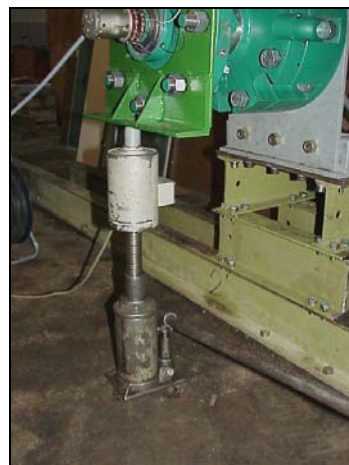
Slika 12: Kalibracija navora (levo) in mase na kolo (desno)
