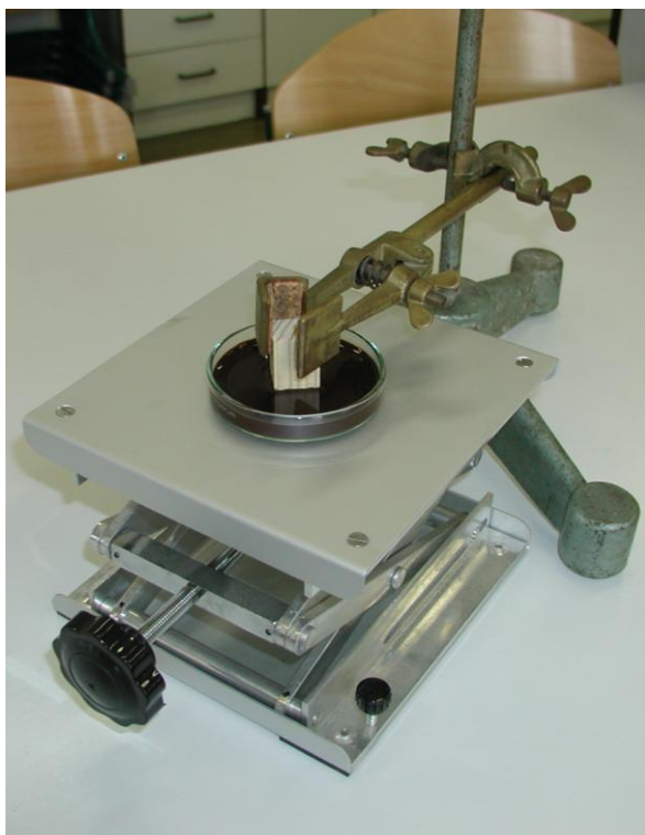
Slika 15: Pomakanje čelnih površin vzorcev z izbranimi premazi
