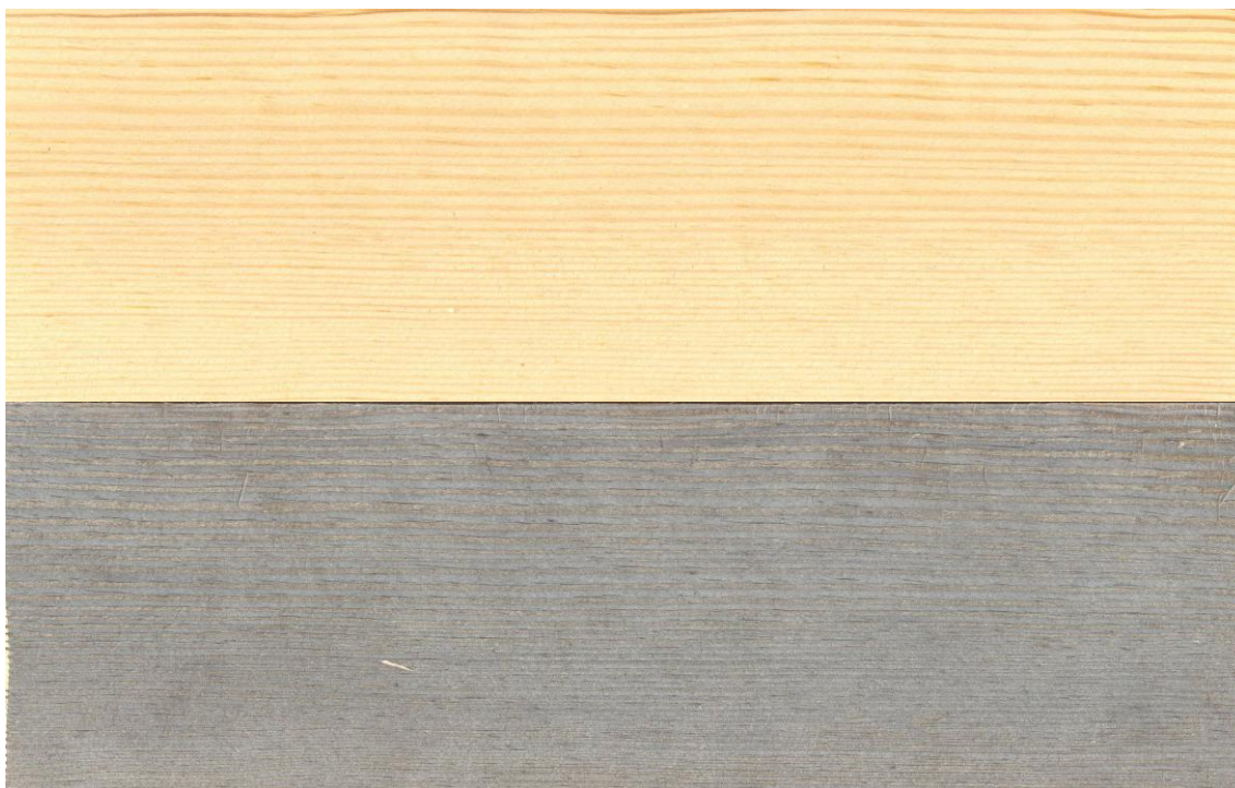
Slika 65: Vzorec nemodificiranega lesa pred staranjem v Ljubljani (zgoraj) in po njem (spodaj)
