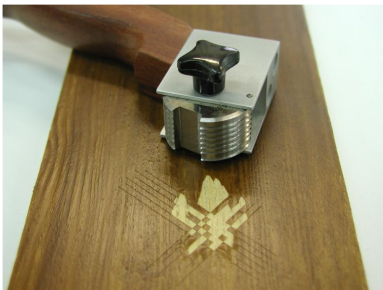
Slika 26: Nož s šestimi rezili za križno zarezovanje z razmikom 2 mm
