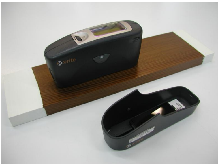
Slika 28: Merilec sijaja X-Rite AcuGloss TRI
