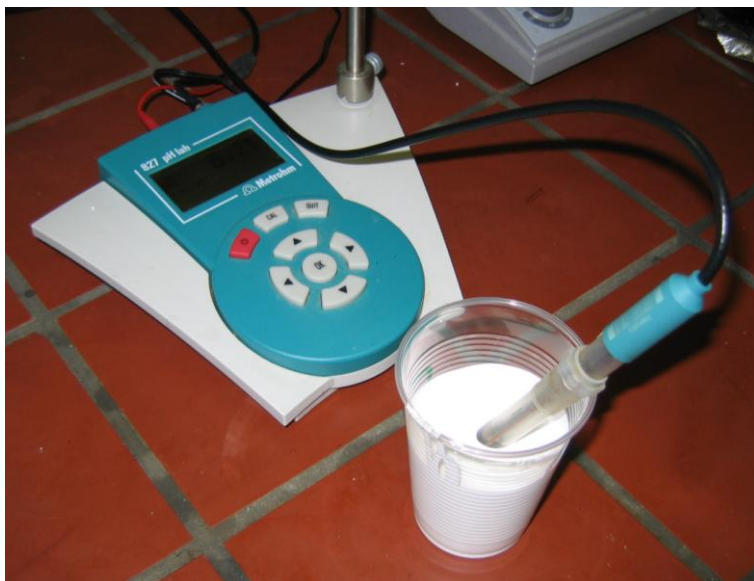
Slika 5: Določanje pH s pH-metrom METROHM 827 pH lab
