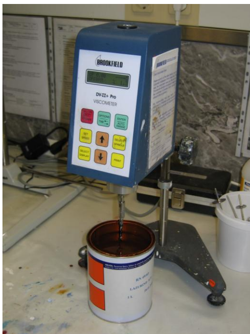
Slika 2: Rotacijski viskozimeter BROOKFIELD viscometer DV-II+ Pro
