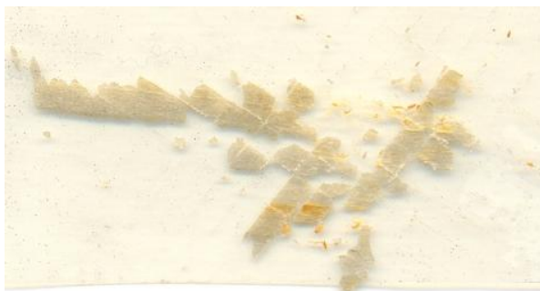
Slika 64: Vlakna termično modificiranega lesa na odtrganem filmu premaza 9
