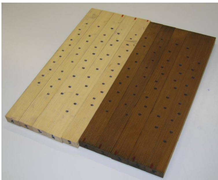
Slika 9: Vzorci za določanje trdote po Brinellu
