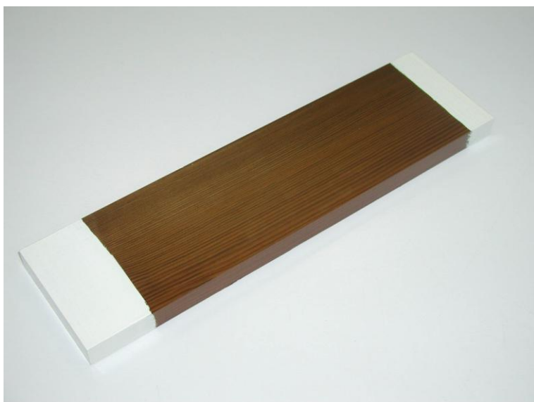
Slika 24: Z leve in desne strani zatesnjen vzorec za naravno staranje po standardu SIST EN 927-3:2001, sistema termično modificiran les – premaz 7
