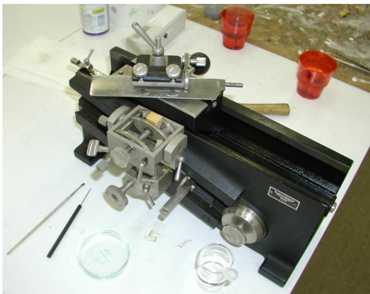
Slika 17: Mikrotom z radialno orientiranim vzorcem
