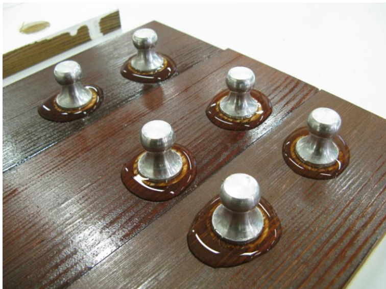
Slika 21: Močenje podlage za določanje mokre oprijemnosti
