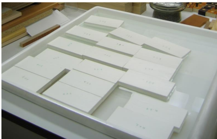
Slika 23: Plavajoči vzorci s testno površino obrnjeno navzdol
