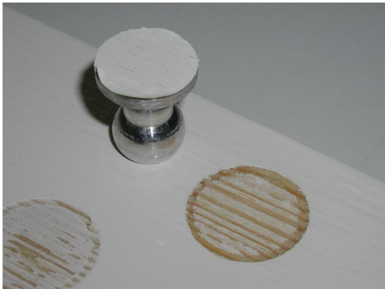
Slika 54: Adhezijski lom med nemodificiranim lesom in premazom 5
