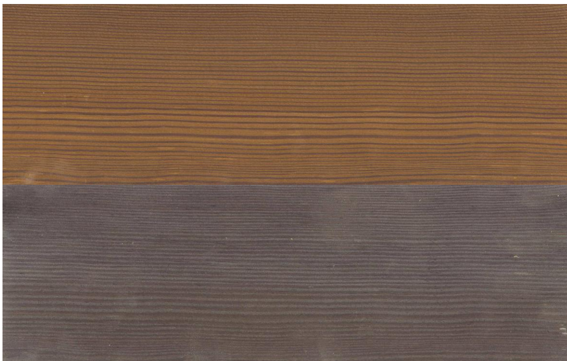
Slika 66: Vzorec termično modificiranega lesa pred staranjem v Ljubljani (zgoraj) in po njem (spodaj)
