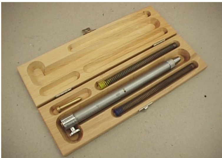
Slika 20: Vzmetni svinčnik za določanje odpornosti proti razenju
