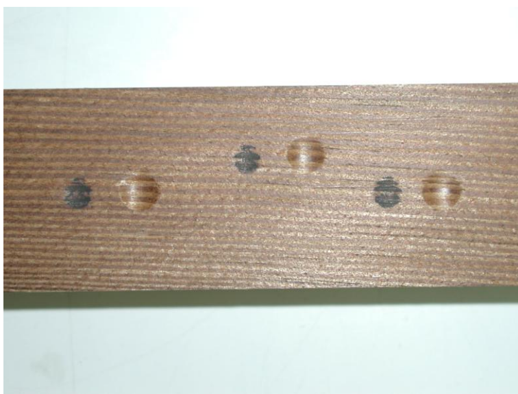
Slika 67: Oblika deformacije po določanju trdote modificiranega lesa z napravo Amsler 120/179 (temno obarvana deformacija) in napravo Zwick Z100 (neobarvana deformacija)
