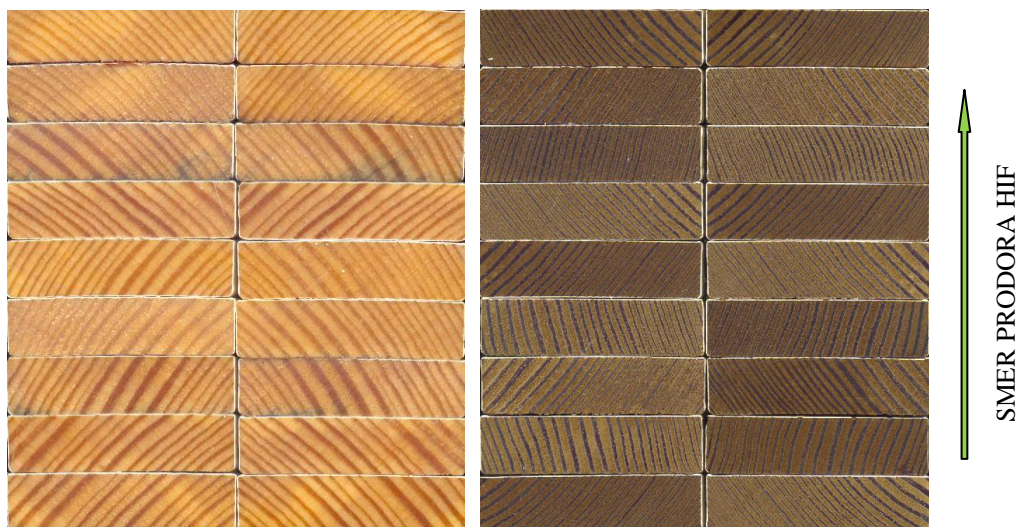
Slika 46: Prečni prerezi vzorcev nemodificiranega (levo) in termično modificiranega lesa (desno) po 6-tedenski izpostavljenosti glivam modrivkam po obrnjeni metodi
