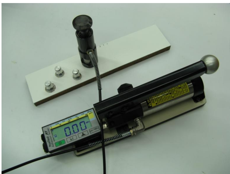
Slika 22: Defelsko PosiTest AT Adhesion Tester za določanje oprijemnosti z metodo odtrgovanja pečatov
