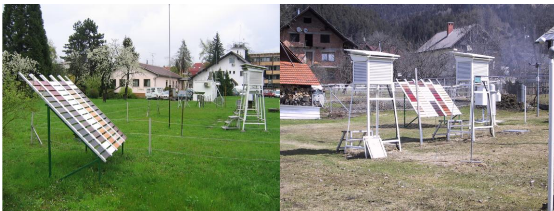
Slika 25: Izpostavljeni vzorci v Ljubljani (levo) in Ratečah (desno) po standardu ISO/DIS 2810:1997
