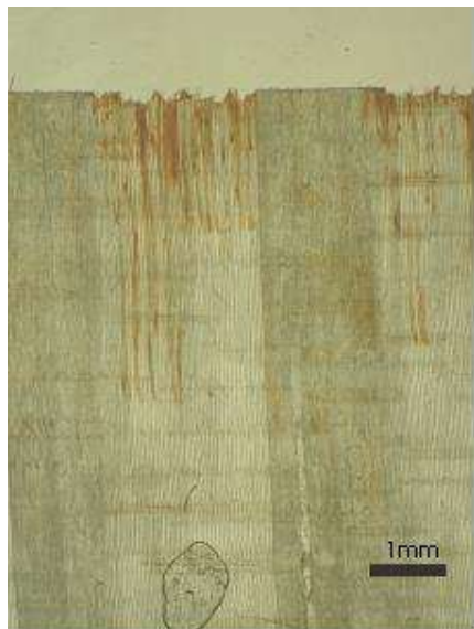
Slika 39: Globina penetracije premaza 2 v nemodificiran les
