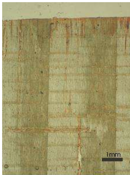
Slika 52: Globina penetracije premaza 8 v DMDHEU modificiran les
