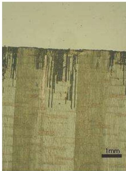
Slika 46: Globina penetracije premaza 5 v DMDHEU modificiran les
