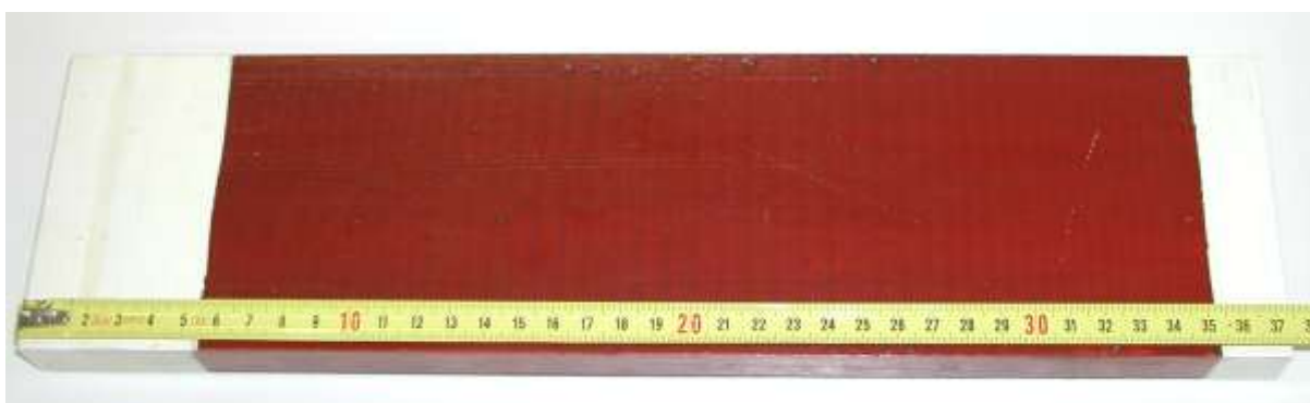
Slika 18: Pripravljen vzorec za izpostavitev naravnemu staranju
