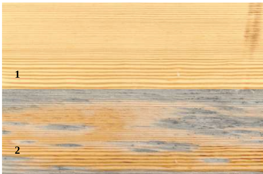
Slika 78: Sistem »nemodificiran les – premaz 7« pred (1) naravnim staranjem v Ljubljani in po njem (2)
