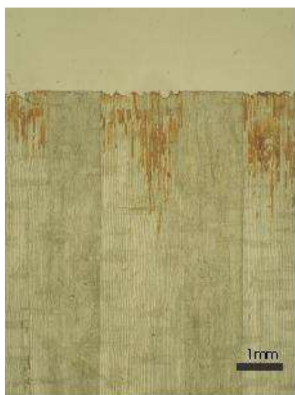
Slika 37: Globina penetracije premaza 1 v nemodificiran les
