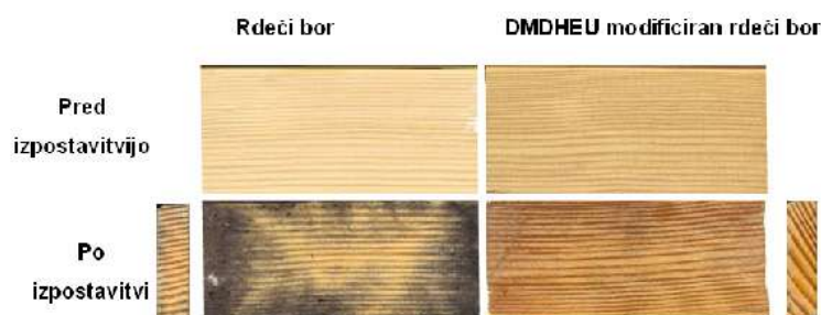
Slika 56: Razlika v pomodrelosti površine lesa rdečega bora in z DMDHEU modificiranega rdečega bora po standardu SIST EN 152-2 (1996)
