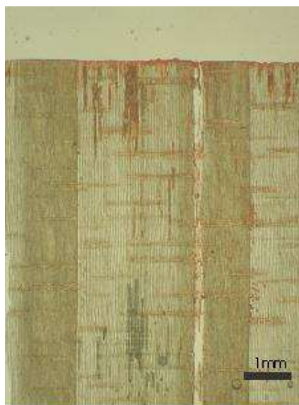
Slika 48: Globina penetracije premaza 6 v DMDHEU modificiran les
