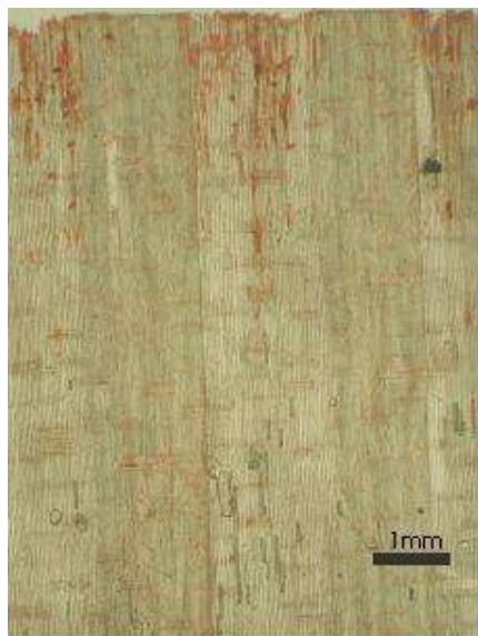
Slika 51: Globina penetracije premaza 8 v nemodificiran les
