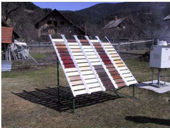
Slika 19: Izpostavitve vzorcev v Ratečah po standardu ISO/DIS 2810 (1997).
