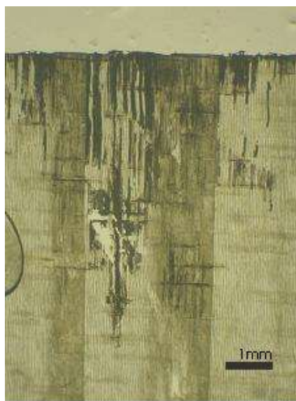
Slika 44: Globina penetracije premaza 4 v DMDHEU modificiran les
