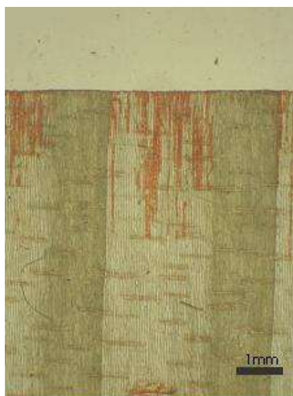
Slika 50: Globina penetracije premaza 7 v DMDHEU modificiran les
