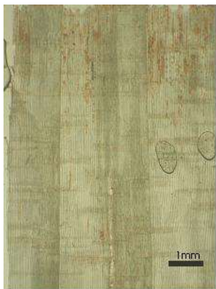
Slika 47: Globina penetracije premaza 6 v nemodificiran les
