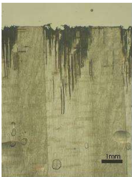
Slika 43: Globina penetracije premaza 4 v nemodificiran les
