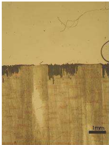
Slika 45: Globina penetracije premaza 5 v nemodificiran les
