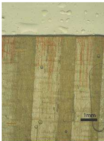
Slika 54: Globina penetracije premaza 9 v DMDHEU modificiran les
