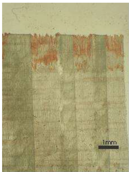
Slika 53: Globina penetracije premaza 9 v nemodificiran les
