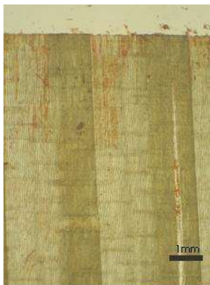
Slika 42: Globina penetracije premaza 3 v DMDHEU modificiran les
