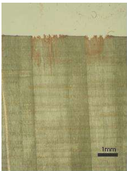
Slika 41: Globina penetracije premaza 3 v nemodificiran les
