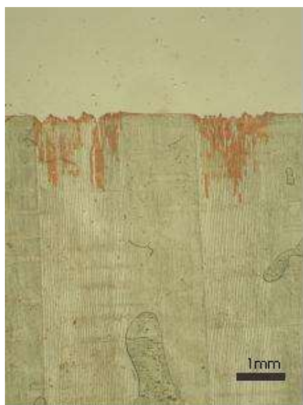
Slika 49: Globina penetracije premaza 7 v nemodificiran les
