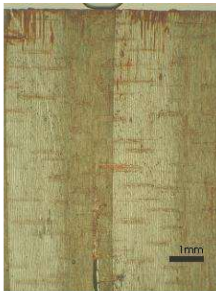
Slika 40: Globina penetracije premaza 2 v DMDHEU modificiran les
