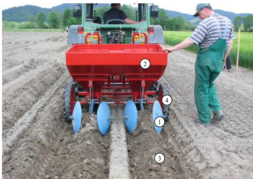
Slika 49: Klasični način saditve z avtomatskim sadilnikom za krompir in osipalnimi diski za oblikovanje majhnih grebenov
