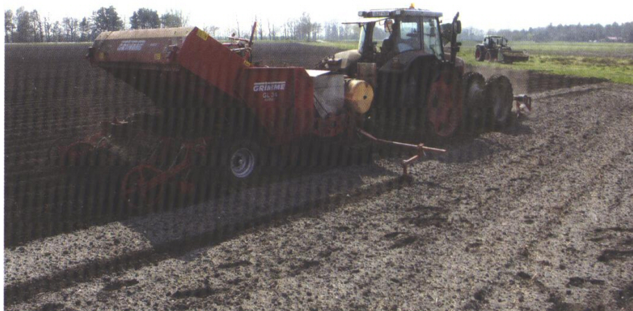
Slika 9: Z dvojnimi ožjimi pnevmatikami na traktorju in 4 pnevmatikami na sadilniku lahko precej zmanjšamo zbitost tal (Peters, 2009: 6)
