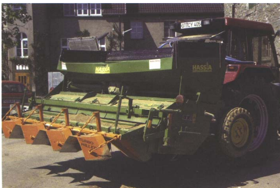
Slika 4: Kombinacija nošenega sadilnika ter gnanega medvrstnega okopalnika z osipalnikom, razvita v praksi pri pridelovalcih krompirja (Peters, 2009: 5)
