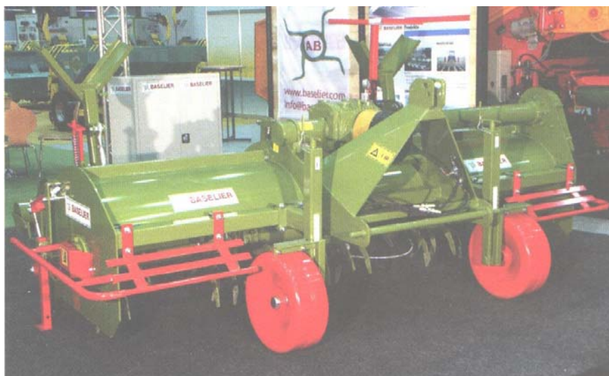
Slika 17: Intenzivnost obdelave tal se na gnanim medvrstnem prekopalniku poveča z večjim številom nožev za okopavanje na rotorju (proizvajalec Baselier z Nizozemske) (Peters in Wulf, 2008: 7)
