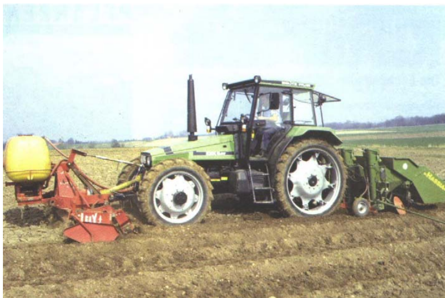
Slika 3: Pri traktorjih s prednjim tritočkovnim priključnim sistemom je mogoče kombinirati nošeni sadilnik zadaj in vrtavkasto brano s škropilnico za razkuževanje gomoljev spredaj (Peters, 2009: 4)
