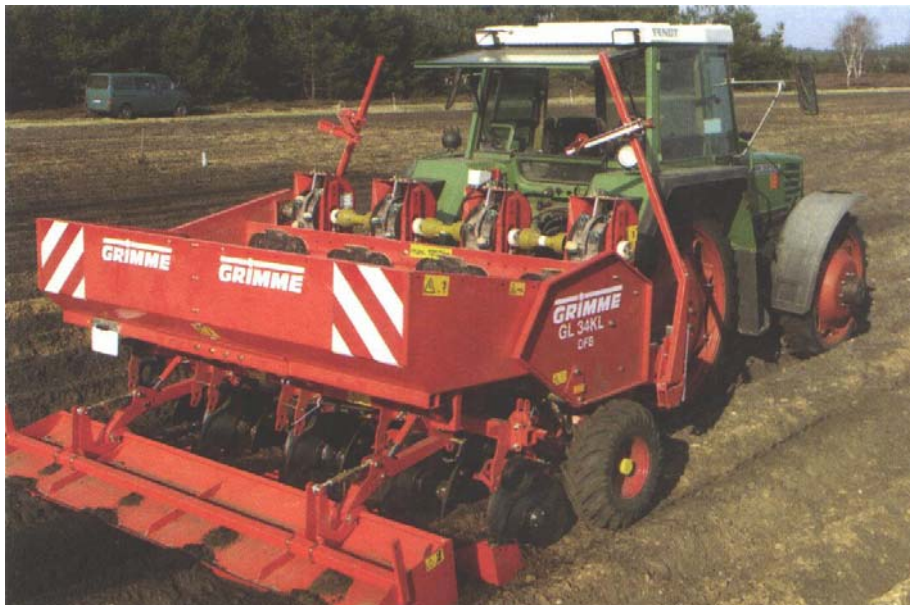
Slika 5: Za saditev in istočasno končno oblikovanje grebenov so na voljo različni osipalniki (Peters, 2009: 5) Figure 5: Various types of ridgers allow simultaneous planting and final ridge formation (Peters, 2009: 5)
