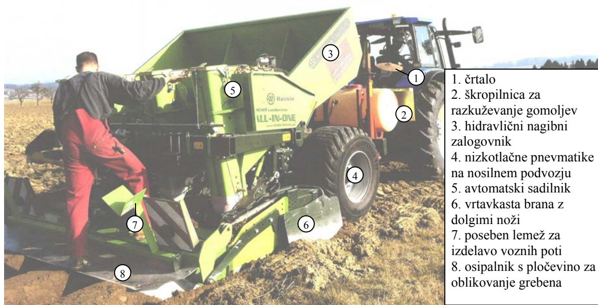
Slika 20: Kombinirani stroj za istočasno pripravo tal, saditev in končno oblikovanje grebenov (Schmid, 2009: 76)
