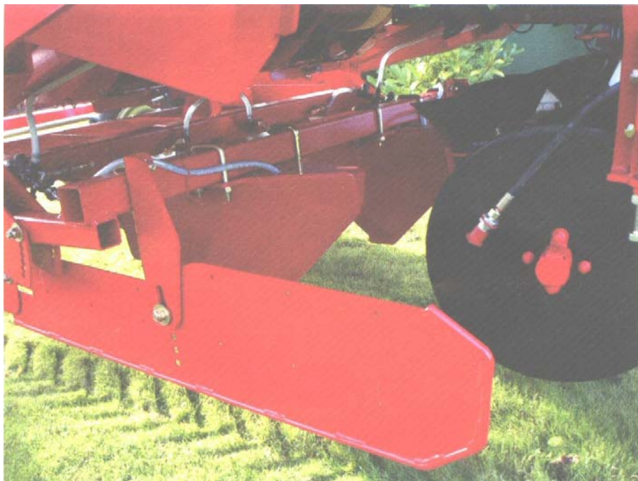
Slika 13: Skupno globinsko vodenje sadilnega lemeža in osipalnika zagotavlja enakomerno pokritost semenskih gomoljev (proizvajalec Grimme iz Nemčije) (Peters in Wulf, 2008: 5)
