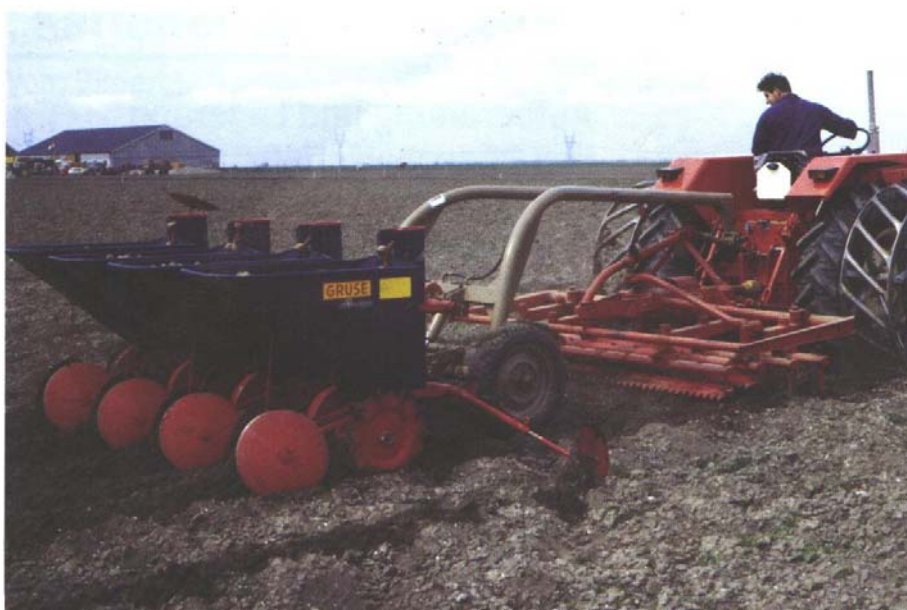
Slika 2: Začetni razvoj: standardni traktor s prekopalnikom za pripravo tal in vlečenim nosilnim ogrodjem za sadilnik (Peters, 2009: 4)
