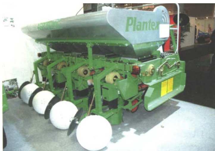
Slika 12: 4-vrstni nošeni avtomatski sadilnik s horizontalnimi zajemali za gomolje proizvajalca Agronomic iz Francije (Peters in Wulf, 2008: 4)
