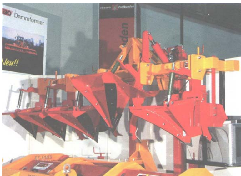
Slika 19: S pomočjo hidravličnega varovanja se pri naletu na skalo dvigne posamezni okopalni in osipalni element navzgor (proizvajalec Zinger z Nizozemske) (Peters in Wulf, 2008: 8)
