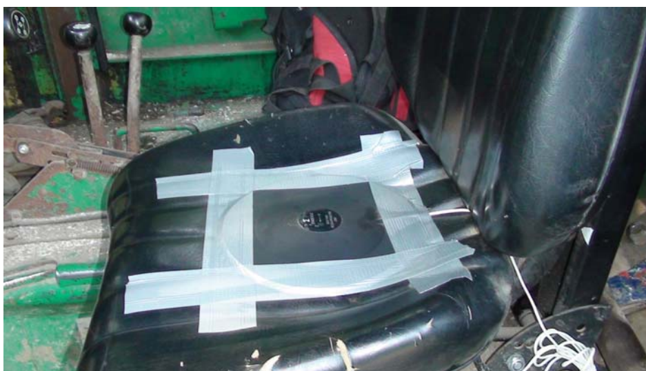
Slika 1: Adapter BRÜEL & KJAER 4515-B-002 na enem izmed sedežev (Foto: Anton Poje)
