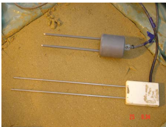
Slika 5: Sonde Trime P2Z (zgoraj) in CS 616 (spodaj).
