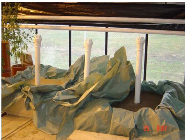
Slika 9: Vstavljene PVC cevi za opravljanje meritev z napravo Diviner 2000. Cevi so lahko do zgornjega roba vkopane v tla.
