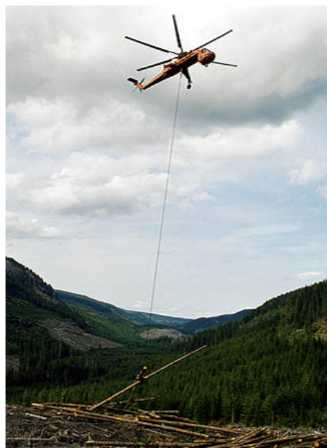
Slika 6: Metoda helikopterskega spravila lesa s kleščami s "choker" navezo ter spravilo posameznih sortimentov (foto: Dunham, M ppt presentation, 2007)
