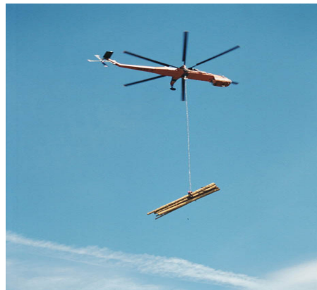
Slika 5: Metoda svežnjev pri helikopterskem spravilu s kleščami (vir: Ericksonaircrane ..., 2007)
