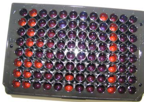
Slika 15: Prikaz mikrotitrne plošče po končani analizi. Rdečkasto-roza obarvane luknjice kažejo, da so v njih žive mikrobne celice, saj so bile sposobne reducirati resazurin v resorufin. Nežive mikrobne celice so v luknjicah, ki so temnejše. V teh luknjicah barvilo ostane modre barve. MIC predstavlja zadnjo luknjico v koloni, ki ni spremenila barve. Dodane reagentne in koncentracije antibiotikov prikazujeta preglednici 4 in 5.
