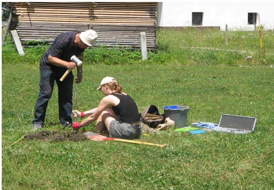
Slika 10: Jemanje vzorcev tal s kopeckyjevim cilindrom.
