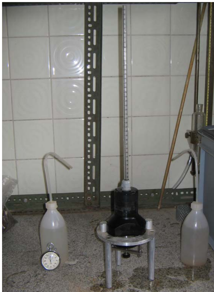
Slika 12: Individualni cilinder za določanje K z variabilnim pritiskom.
