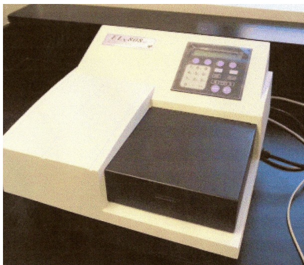
Slika 4: Spektrofotometer Elx808 s katerim smo merili absorbanco pri 450 nm
