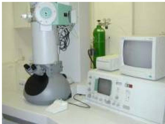
Slika 12: Transmisijski elektronski mikroskop (Stušek in sod., 1997)
